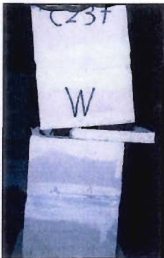
Bild 49 Versagenszustand – Kleinprüfkörper C 2 3 / KS – MG II – e = t/2 - 1,0 cm
