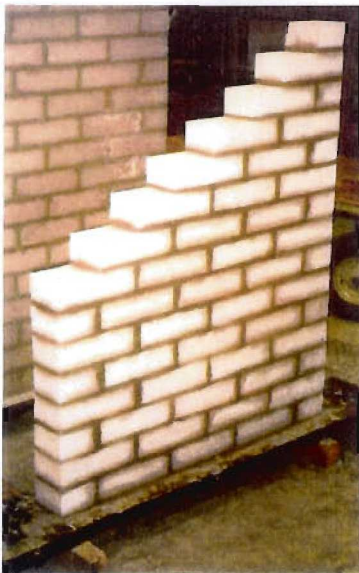
Bild 31 Herstellung Wandprüfkörper aus Kalksandsteinen
