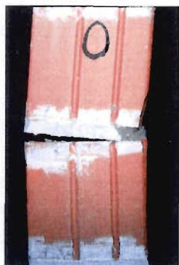
Bild 47 Versagenszustand – Kleinprüfkörper A 3 3 / HLz – 2 DF - MG III – e = t/2 - 1,5 \text{ cm}
