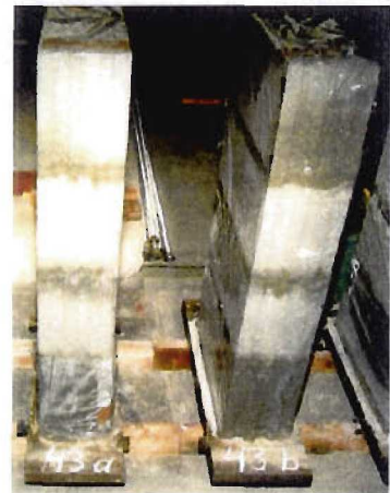
Bild 30 Lagerung Kleinprüfkörper aus Leichtbetonsteinen
