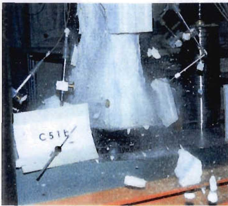
Bild 42 Versagenszustand – Kleinprüfkörper C 5 1 / KS – Quadro – DM – e = 0
