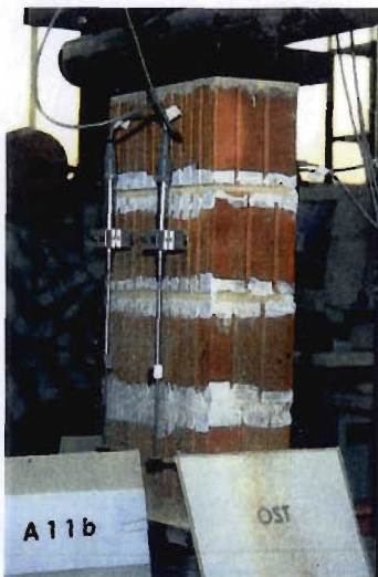
Bild 37 Versagenszustand – Kleinprüfkörper A 1 1 / HLz – 2 DF – MG I – e = 0
