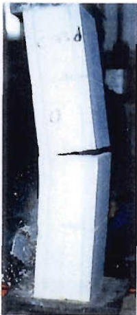
Bild 51 Versagenszustand – Kleinprüfkörper C 5 3 / KS – DM – e = t/2 - 1,5 \text{ cm}
