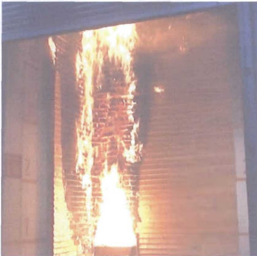
Abb. 5.22 Flammenausbreitung nach 19 Minuten
