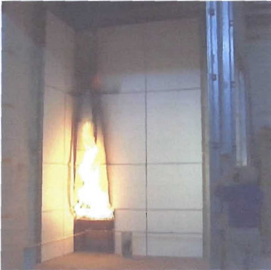
Abb. 5.7 Flammenausbreitung nach 19 Minuten
