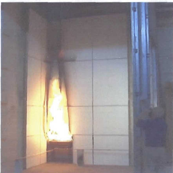
Abbildung 7.3: Versuchsaufbau Nr. 3 Faserzement auf Holzunterkonstruktion mit Sturz aus Stahl
