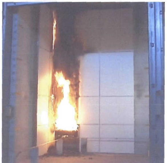
Abbildung 7.8: Versuchsaufbau Nr. 7 HPL-Platte auf Aluminium-Unterkonstruktion
