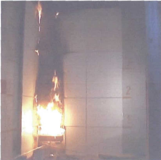
Abb. 5.16 Flammenausbreitung nach 19 Minuten
