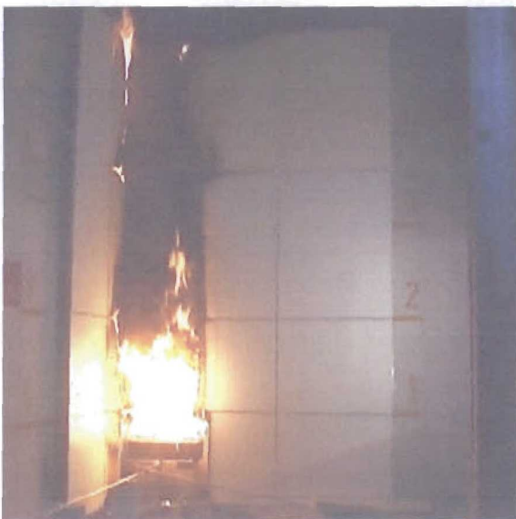
Abbildung 7.7: Versuchsaufbau Nr. 6 HPL-Platte auf Aluminium-Unterkonstruktion mit Sturz aus Stahl
