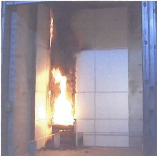
Abb. 5.19 Flammenausbreitung nach 19 Minuten
