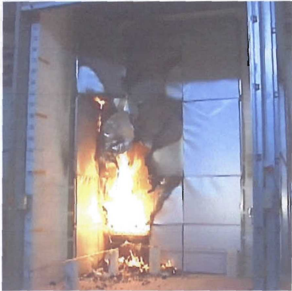
Abbildung 7.5: Versuchsaufbau Nr. 4 Aluminiumverbund-Kassetten mit Querriegel
