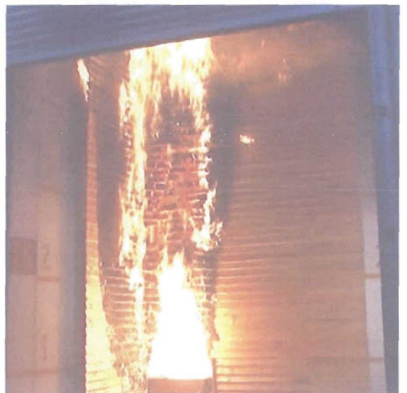
Abbildung 7.4: Versuchsaufbau Nr. 8 Holzstülpeschalung auf Holzunterkonstruktion
