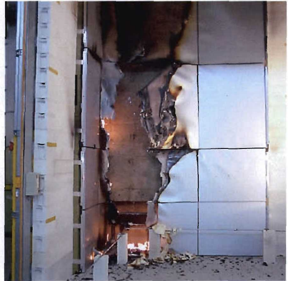
Abbildung 7.14: Auflösung des Aluverbundelementes
