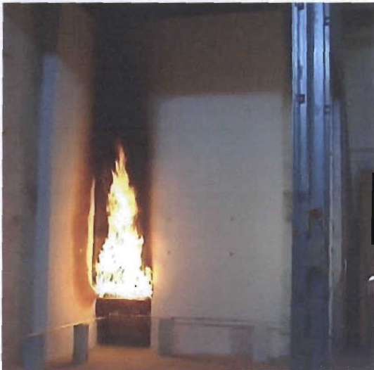
Abb. 5.25 Flammenausbreitung nach 19 Minuten
