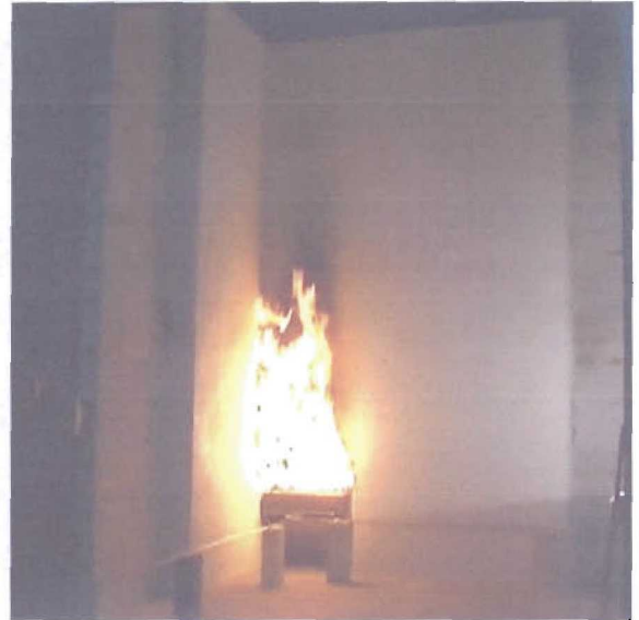
Abbildung 7.10: Versuchsaufbau Nr. 10 WDVS mit mineralischem Putz
