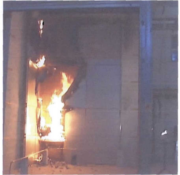
Abbildung 7.6: Versuchsaufbau Nr. 5 Aluminiumverbund-Kassetten mit Sturz aus Stahl
