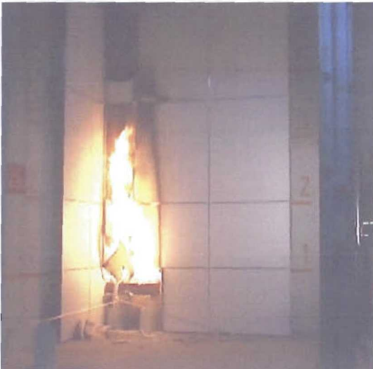
Abb. 5.1 Flammenausbreitung nach 19 Minuten
