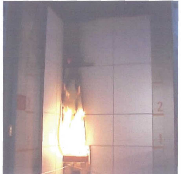
Abbildung 7.2: Versuchsaufbau Nr. 2 Faserzement auf Holzunterkonstruktion
