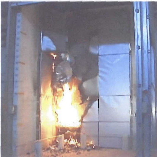
Abb. 5.10 Flammenausbreitung nach 19 Minuten
