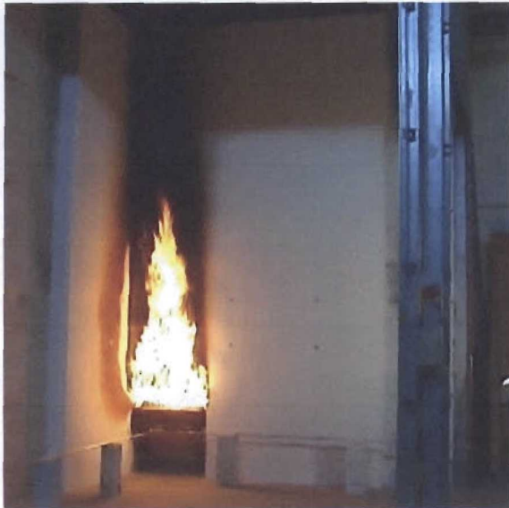
Abbildung 7.9: Versuchsaufbau Nr. 9 WDVS mit organischem Putz
