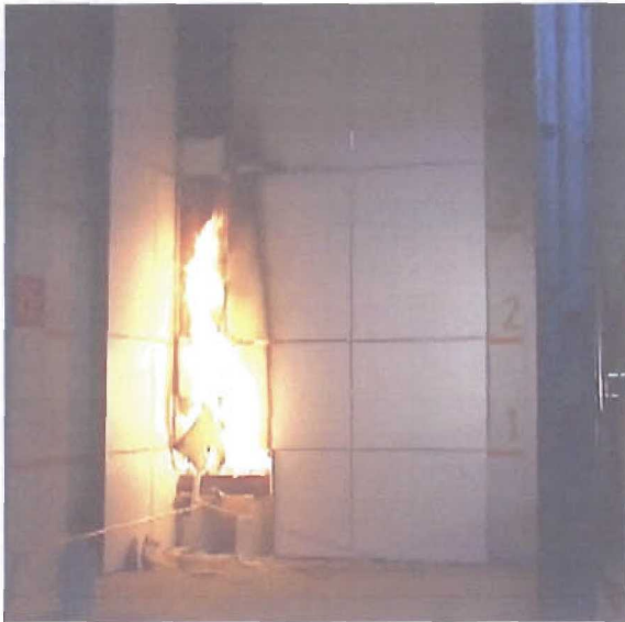
Abbildung 7.1: Versuchsaufbau Nr. 1 Faserzement auf Aluminium-Unterkonstruktion
