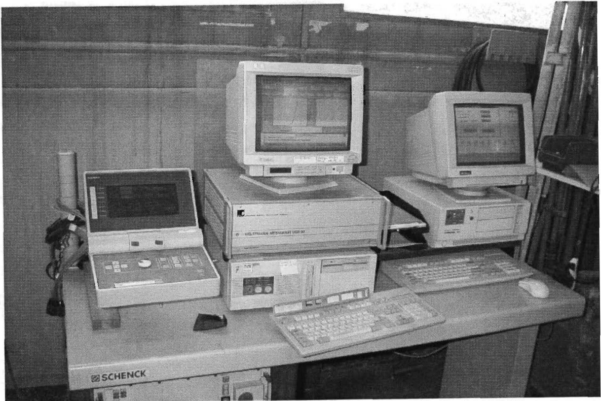
Bild 3.9: Steuerpult der Schenck PSB-1000 mit Vielstellenmessgerät
