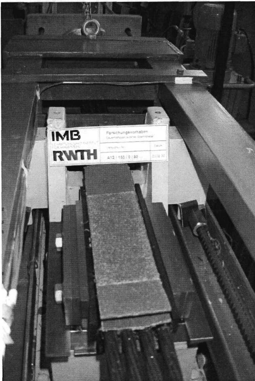
Bild 4.28: Anordnung von Sandpapier zur Erzielung von innerer Gleitung
