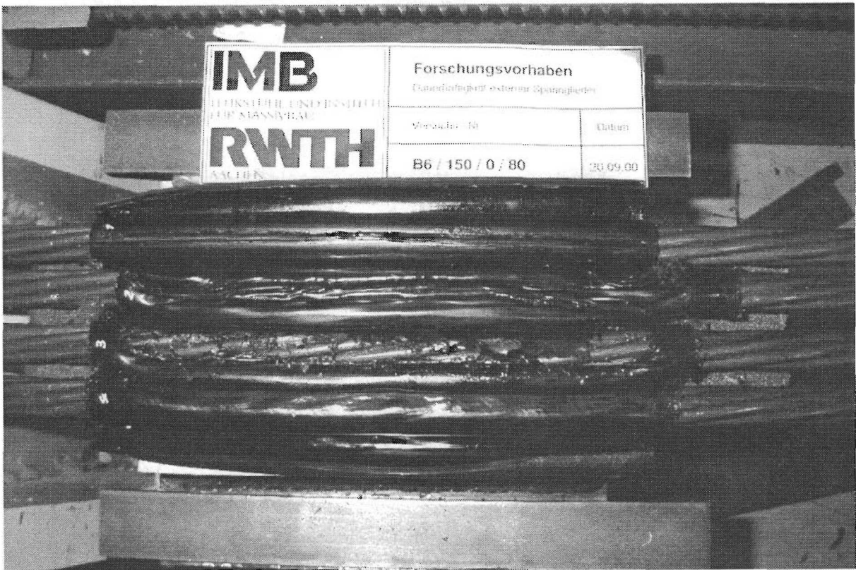
Bild 4.35: Aufreißen der inneren Schutzhülle bei Spannglied Serie B
