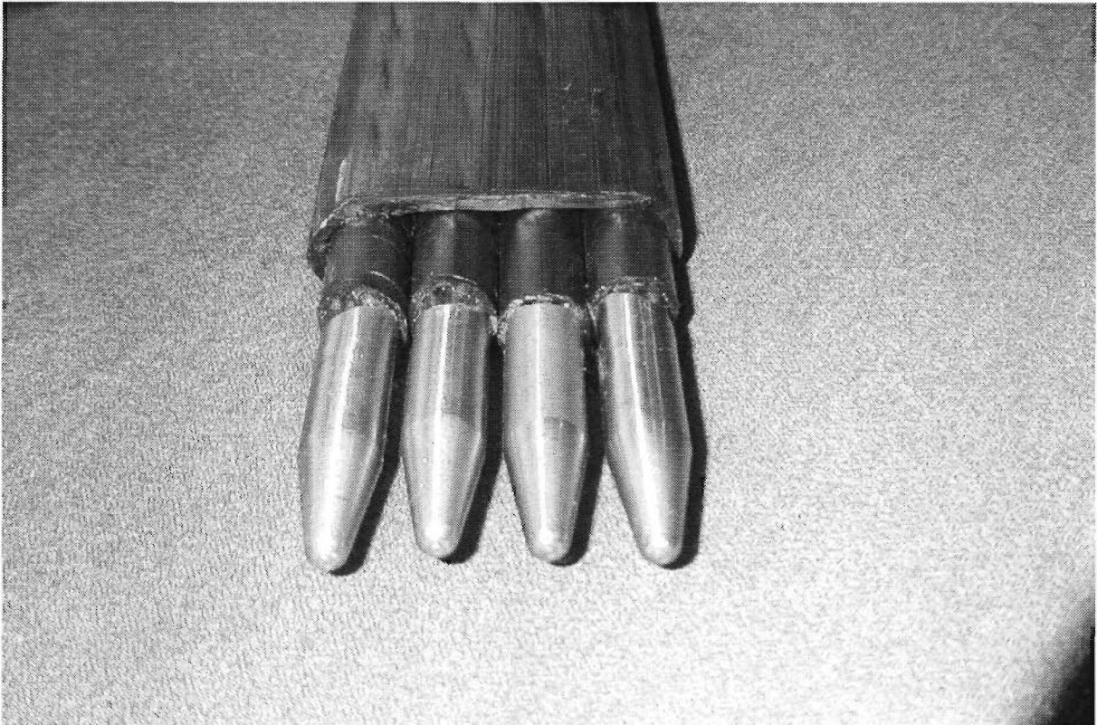
Bild 3.12: Spanngliedprobe mit aufgeschobenen Einfädelhülsen
