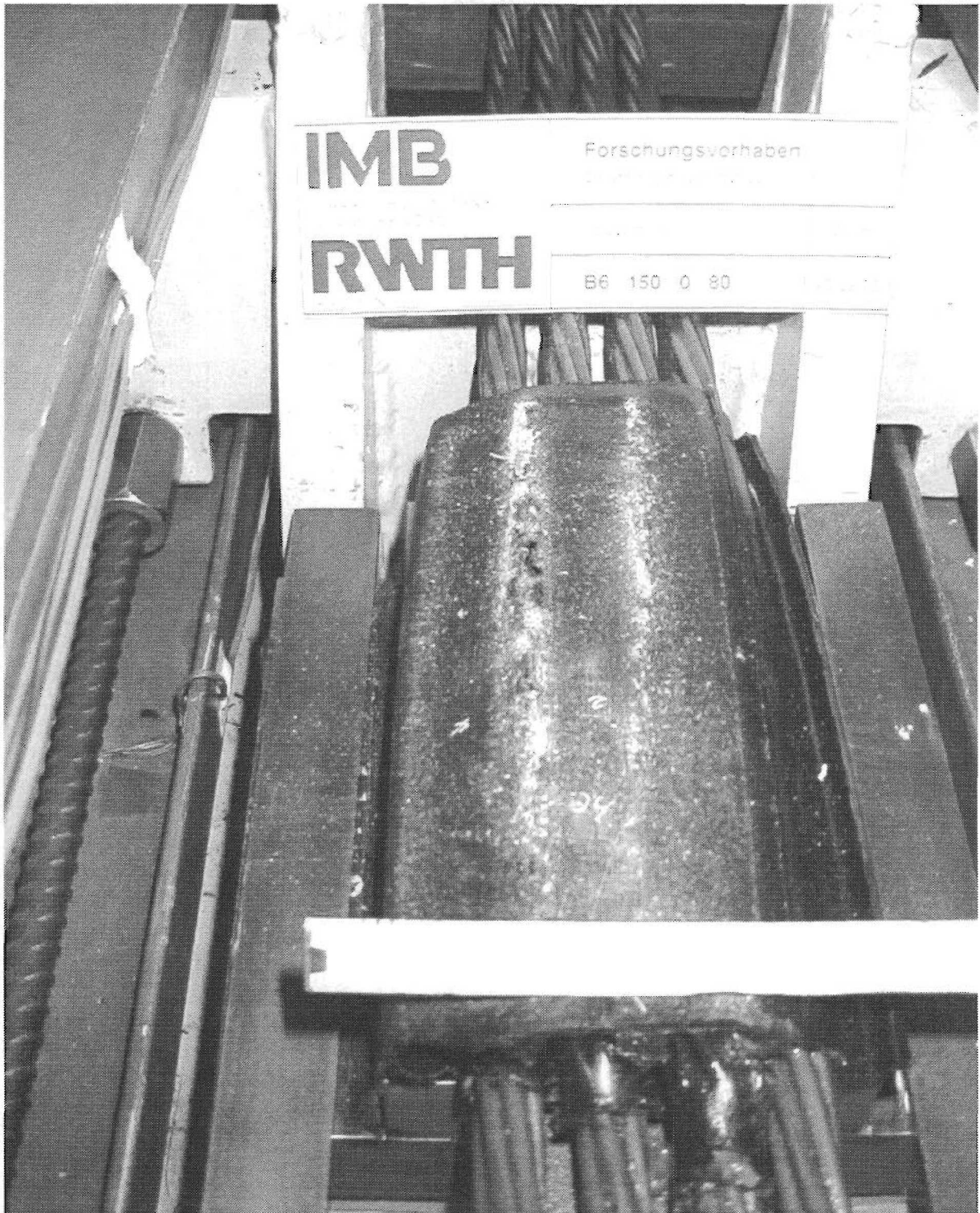
Bild 4.34: Aufreißen der äußeren Schutzhülle bei Spannglied Serie B
