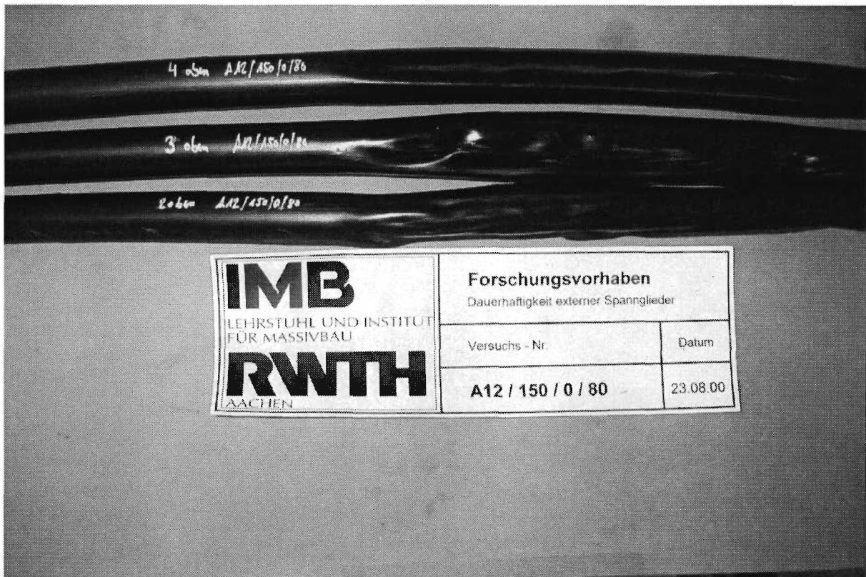
Bild 4.33: Faltungen der Monolithenhüllen bei innerer Gleitung und einer Drehbewegung der Litzen
