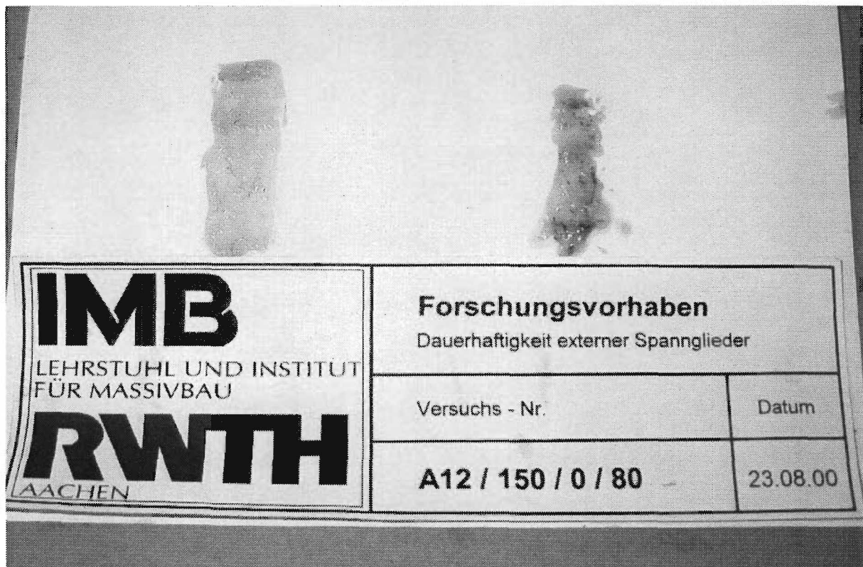
Bild 4.31: Korrosionsschutzmittel bei äußerer Gleitung (links) und innerer Gleitung (rechts)
