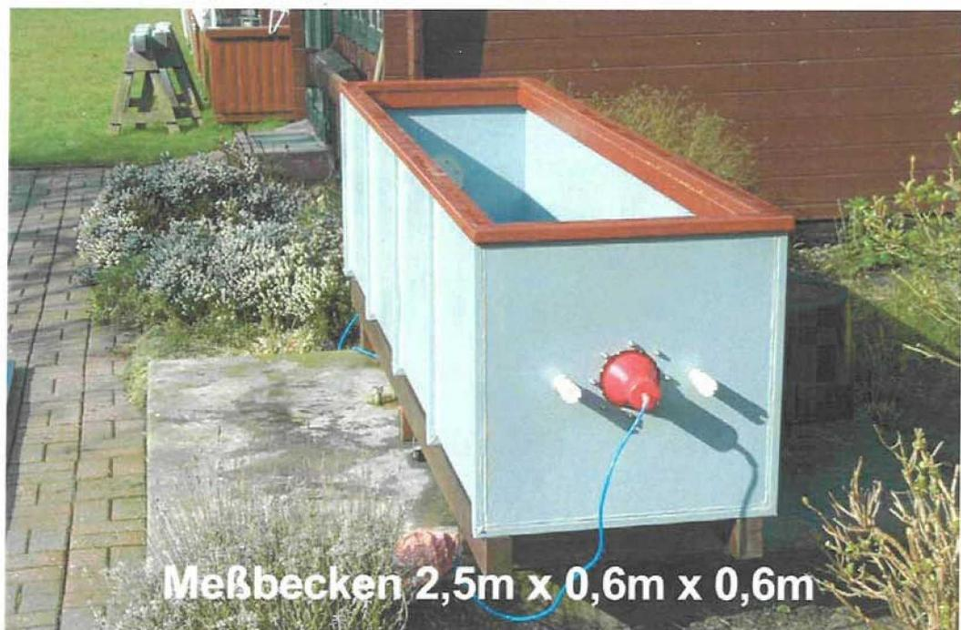
Abbildung 8: Messbecken für die Systemversuche Teil II
