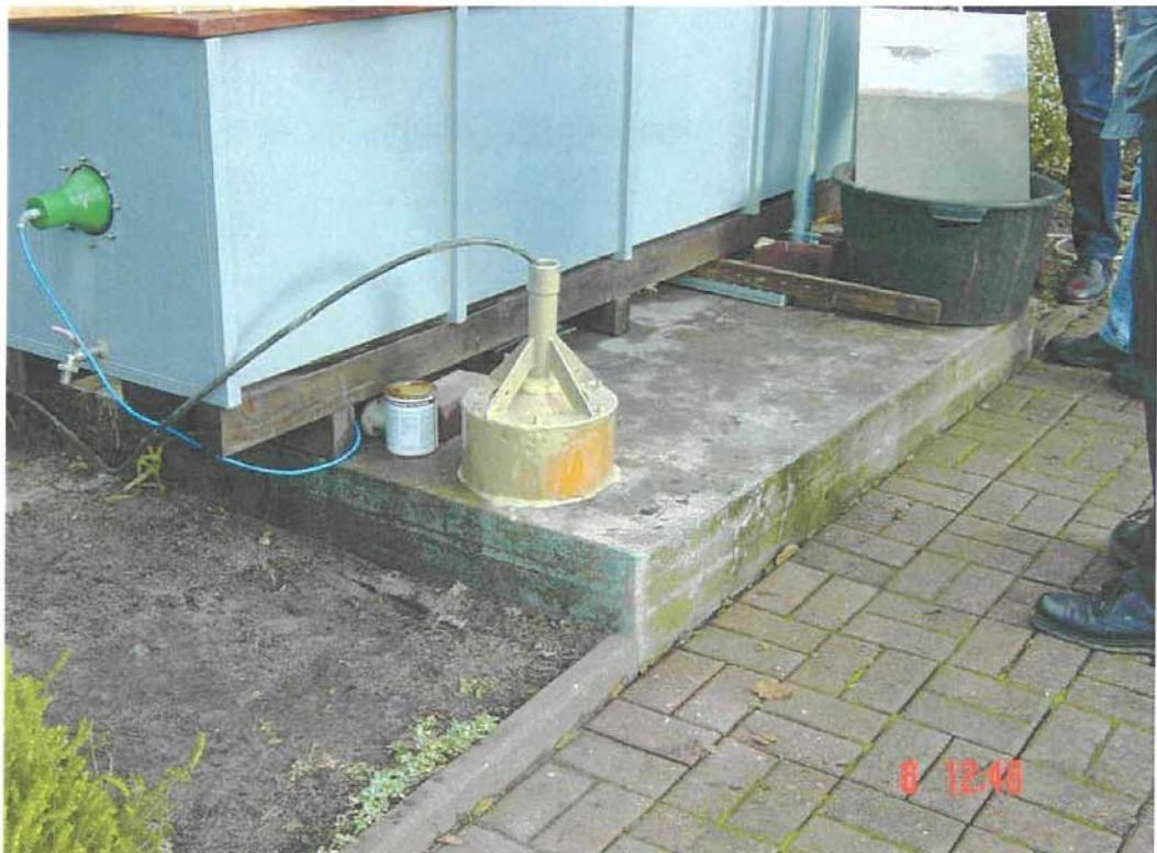
Abbildung 10: 15 kHz und 200 kHz Sender neben dem Stahlbecken
