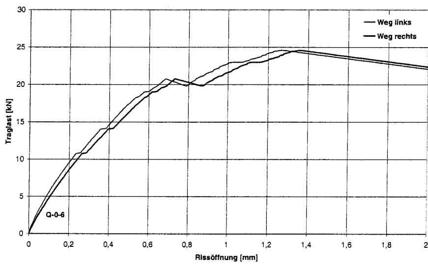
Bild A-4 bis A-6: Last-Verschiebungs-Diagramme für Q-0-4 bis Q-0-6
