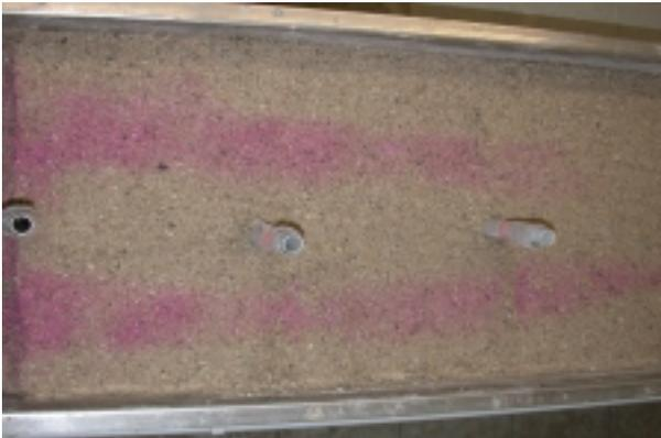
**Bild 27:** Beispiel für Phenolphthaleintest, ca. 1 cm unter der ursprünglichen Sandoberfläche
