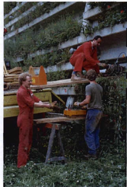
Bild 3.1-9 Abhebeprüfung an Lisenenanker (1990)
