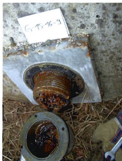
Bild 3.1-33 zu wenig und verfärbte Paste
