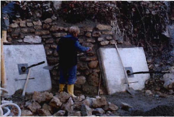
Bild 3.13-5 Stahlbetonplatten zur Krafteinleitung
