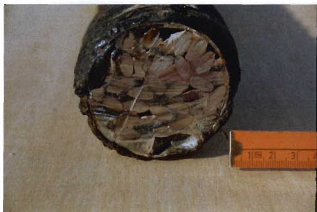
Bild 3.15-5 Schnitt durch ein Spannglied
