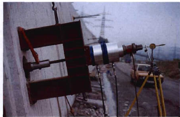
Bild 3.6-5 Abhebeversuch an einem Anker (1984)
