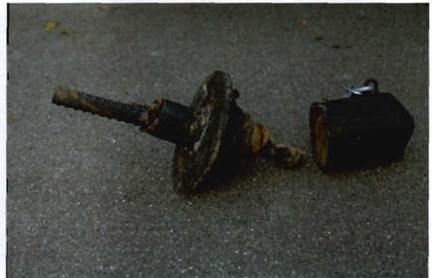
Bild 4-8 Gebrochener Einstabanker (Foto: Dipl.-Ing. Meiniger)
