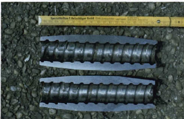
Bild 4-11 Ungenügende Einschraublänge in einer Koppelmuffe (Foto: Dipl.-Ing. Meiniger)
