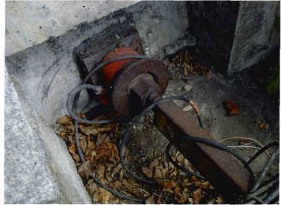
Bild 3.7-10 Anker im Kopfbalken mit Kraftmeßeinrichtung (2002)
