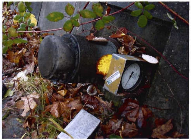
Bild 3.10-6 Kraftmeßdose, Ankerkraftanzeige nahe Null
