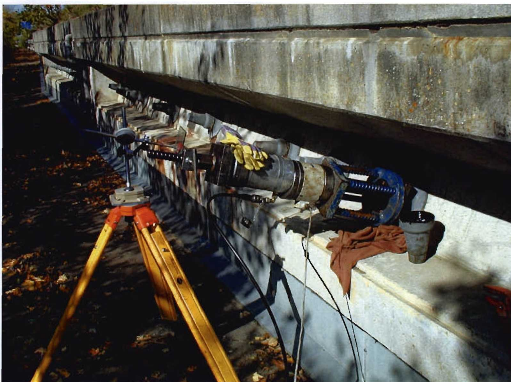
Bild 3.2-10 Abhebeversuch an einem Anker
