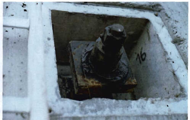
Bild 4-12 Loser Ankerkopf nach Stahlbruch (Foto: Dipl.-Ing. Meiniger)
