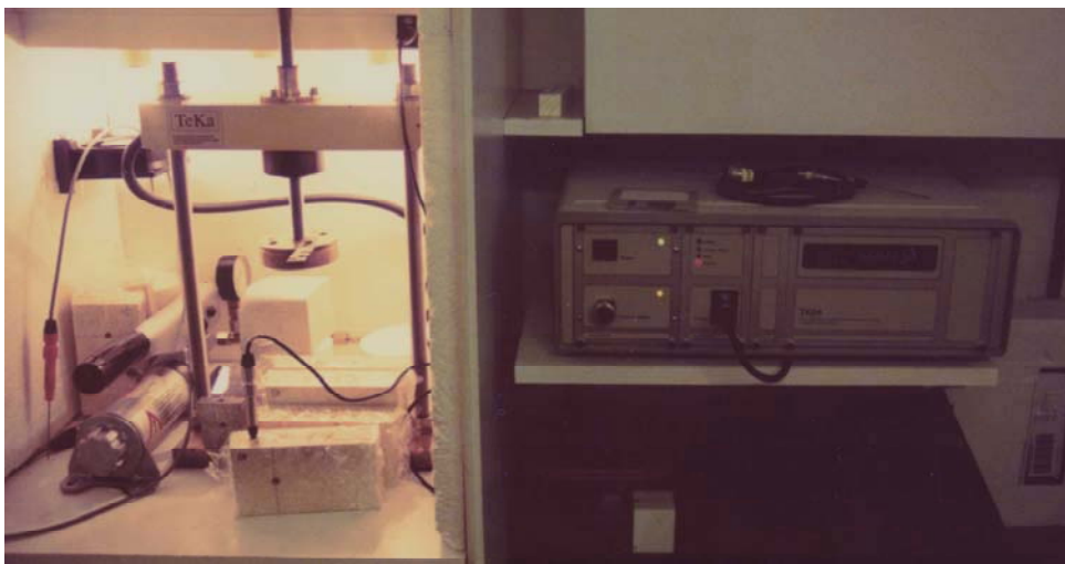
Bild 29: Versuchsaufbau zur Messung der Wärmeleitfähigkeiten
