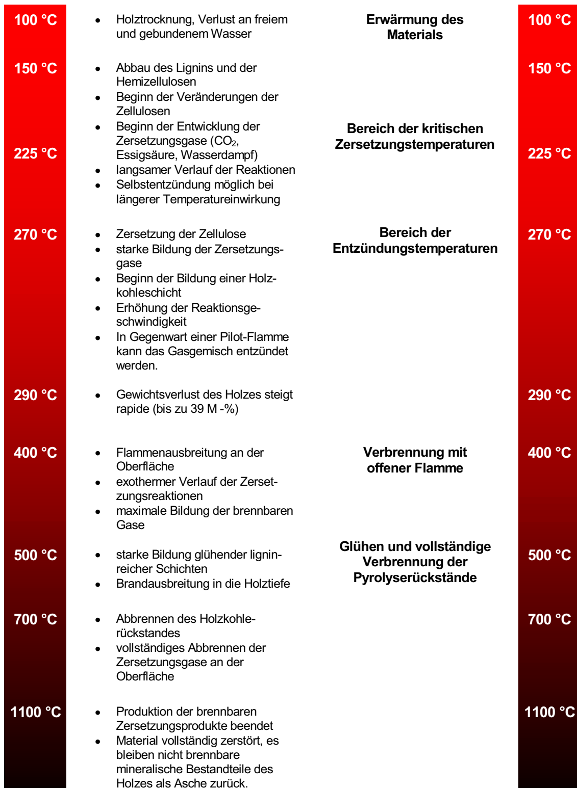
Bild 2: Phasen der thermischen Zersetzung von Holz nach Huntierova [44]; ergänzt durch Angaben von Lache [58] und Hoffmann [43]
