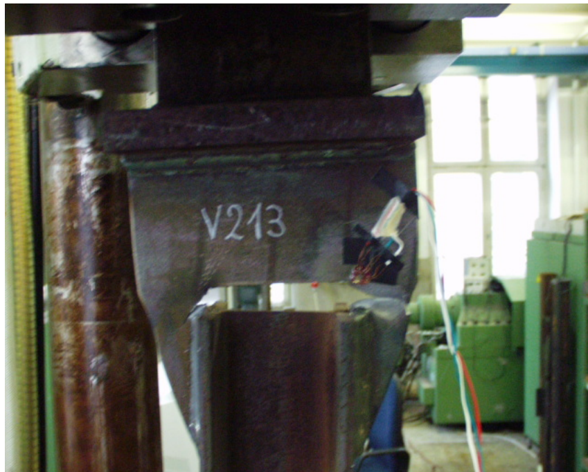
Bild 5.9 V213 im Bruchzustand, stabiler Rissfortschritt nach mäßiger Plastizierung vor Rissbeginn
