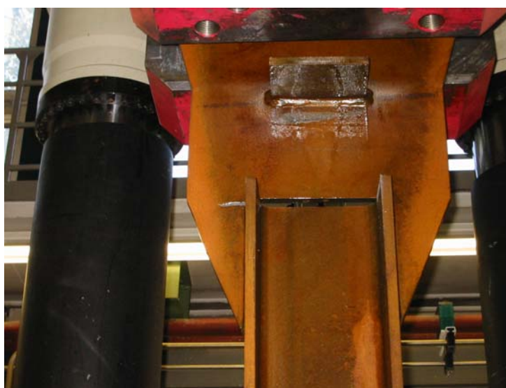
Bild 5.5 V131 im Bruchzustand, stabiler Rissfortschritt nach großer Plastizierung vor Rissbeginn
