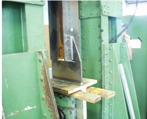
Bild 5.1 V111 im Bruchzustand, stabiler Rissfortschritt nach mäßiger Plastizierung vor Rissbeginn
