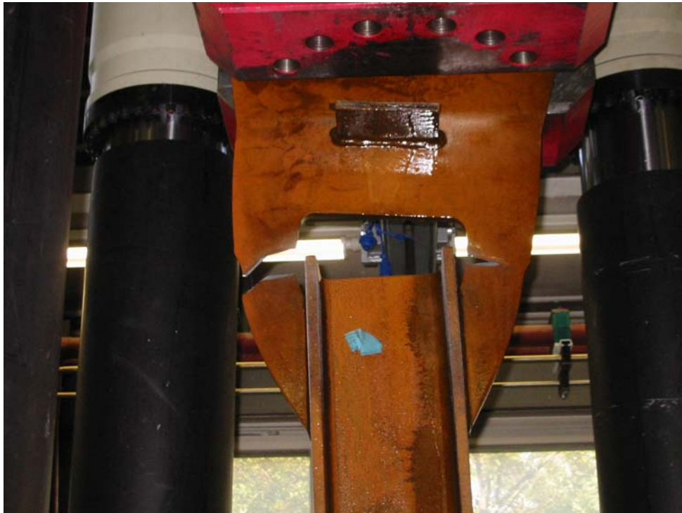
Bild 5.6 V151 im Bruchzustand, stabiler Rissfortschritt nach sehr großer Plastizierung vor Rissbeginn
