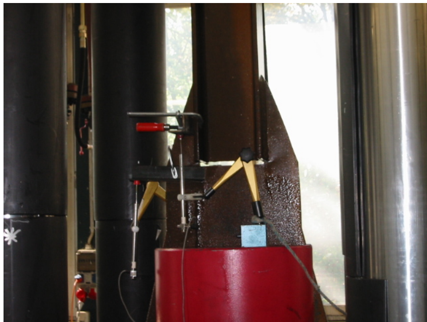
Bild 5.11 V311 im Bruchzustand, stabiler Rissfortschritt nach mäßiger Plastizierung vor Rissbeginn
