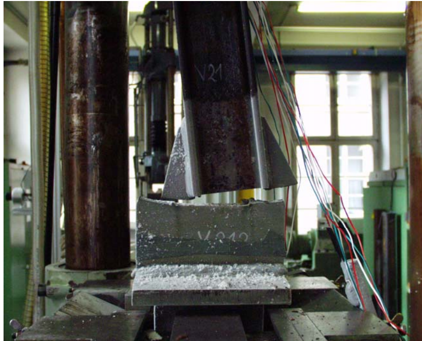
Bild 5.8 V212 im Bruchzustand, instabiler Rissfortschritt nach mäßiger Plastizierung vor Rissbeginn
