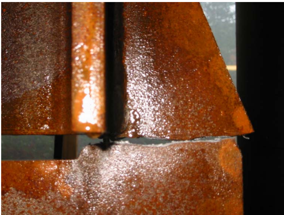
Bild 5.7 V161 im Bruchzustand, instabiler Rissfortschritt nach sehr großer Plastizierung vor Rissbeginn
