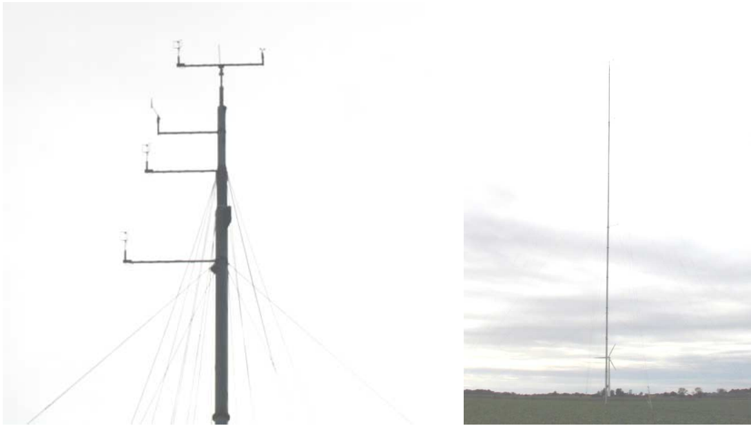
Abbildung 20 Bild des Messmasts 2 mit den Ultraschallanemometern. Links im eingefahrenen Zustand, rechts aufgerichtet und ausgefahren.
