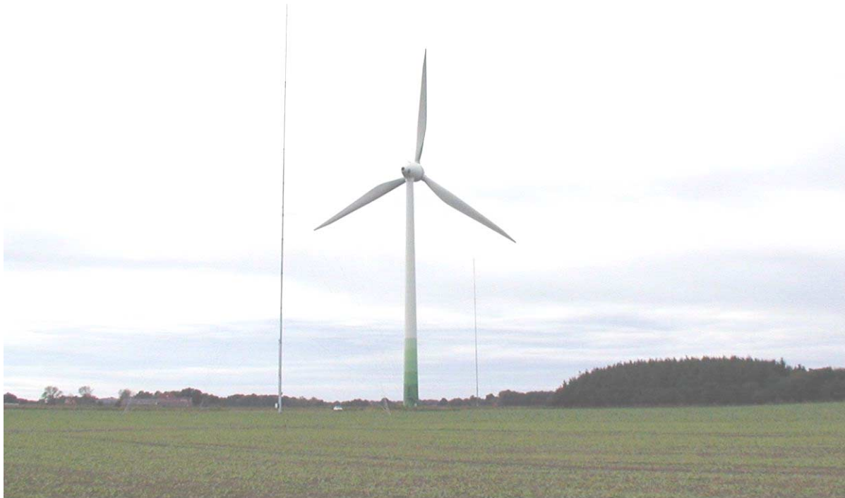
Abbildung 18 Standort Hage: Im Vordergrund der mit Ultraschallanemometern bis Nabenhöhe ausgestattete Messmast, hier im direkten Nachlauf der Windenergieanlage.
