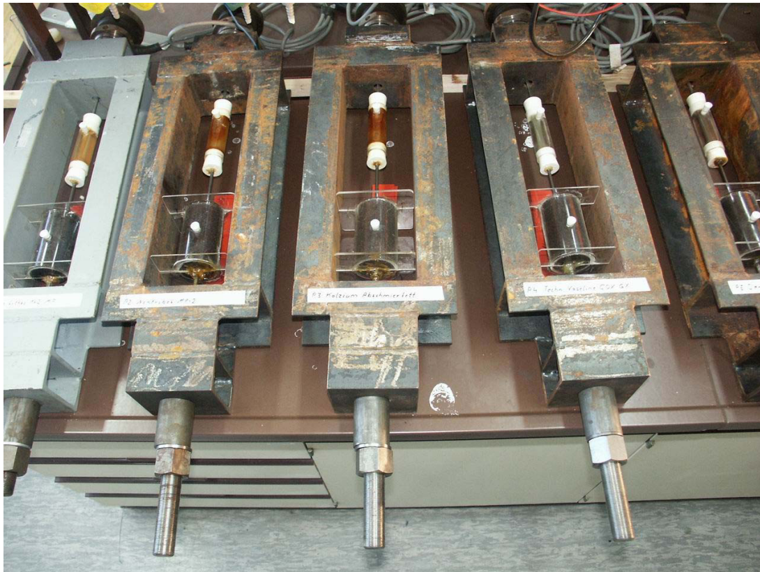
Abb. 3: Übersicht Spannrahmen mit beschichteten Spannstäben unter Zugbelastung, die jeweils in verschiedenen Abschnitten mit einem aggressiven Boden der Bodenklasse III sowie in einem Abschnitt mit einer äquivalenten Lösung entsprechend der Bodenklasse III beansprucht werden
