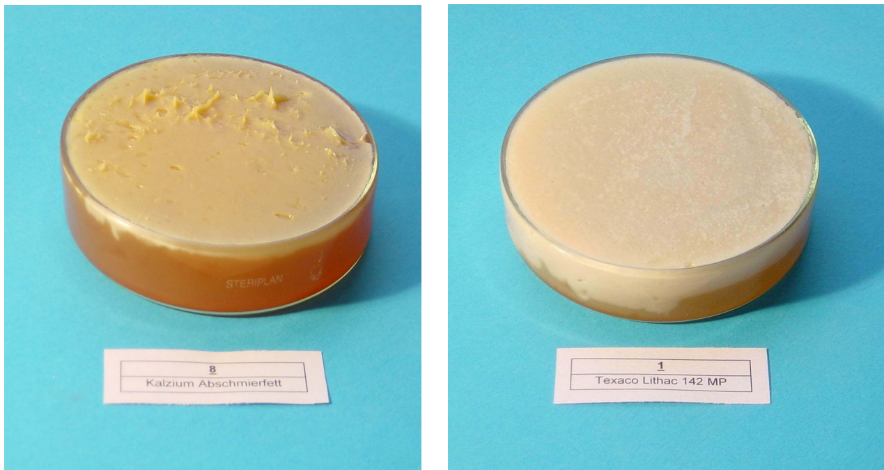
Abb. 8: Proben Kalzium Abschmierfett (links) und Texaco Lithac (rechts) nach 90 Tagen im Kondenswasser-Konstantklima (30°C) in Anlehnung an DIN 50017
