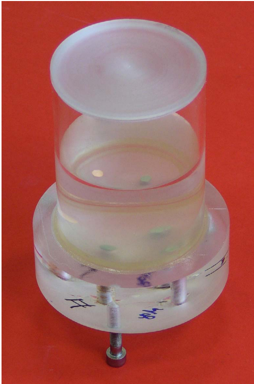
Abb. 6: Messzelle zur Prüfung der Schutzwirkung von Korrosionsschutzmassen
