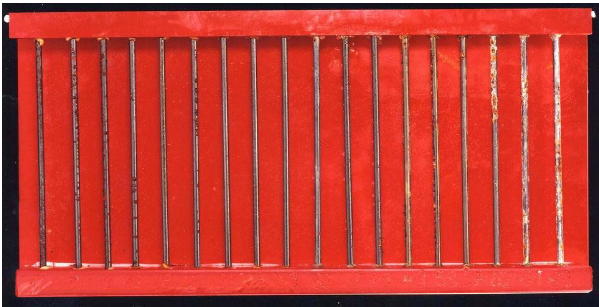
Abb. 16: Spannstaahlproben mit 0,07 mm Schichtdicke nach 100 Tagen im Kondenswasser-Konstantklima (30°C) in Anlehnung an DIN 50017; von links jeweils drei Stäbe: Texaco Lithac 142 MP, Nontribos MP-2, Kalzium Abschmierfett, Technische Vaseline COX GX, Denso Technische Vaseline, Denso-Jet.
