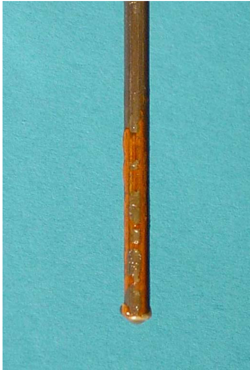
Abb. 32: Aussehen der Spannstabprobe Kalzium-Abschmierfett mit einer Schichtdicke von 0,07 mm nach 20 h in der Bodenlösung
