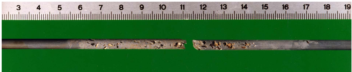
Abb. 25: Spannstab – Korrosionsschutzmasse Nontribos MP-2 (gebeizt) – nach 421 Tagen im aktivierten Boden (Klasse III) gerissen
