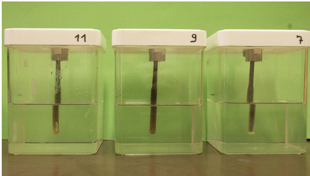
Abb. 5: Probenpräparation für elektrochemische Messungen
