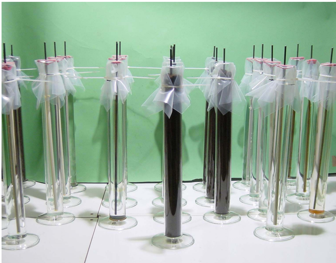
Abb. 2: Probenaufstellung für die Auslagerungsversuche in künstlicher Bodenlösung und im aktivierten Boden Klasse III, mit starker Bodenaggressivität
