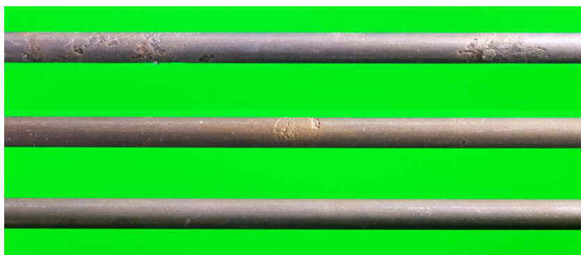
Abb. 23: Stababschnitte von jeweils 10 cm nach dem Beizen, ausgelagert im aktivierten Boden mit perforierter Um-mantelung, von oben: Nontribos MP-2, Texaco Lithac 142 MP, Denso Techn. Vaseline
