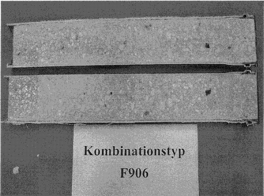
**Bild 2:** Sedimentationsprüfung am Festbeton; Kombinationstyp
