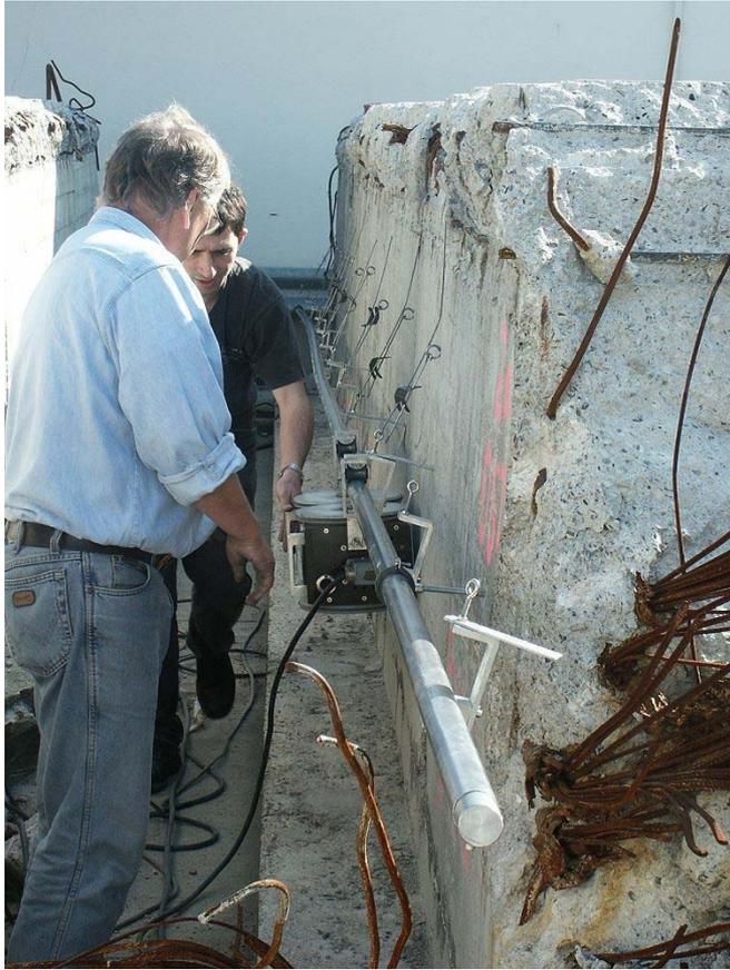
Abb. 14: Befestigung der Messeinrichtung der TU Berlin Träger 2a Ost
