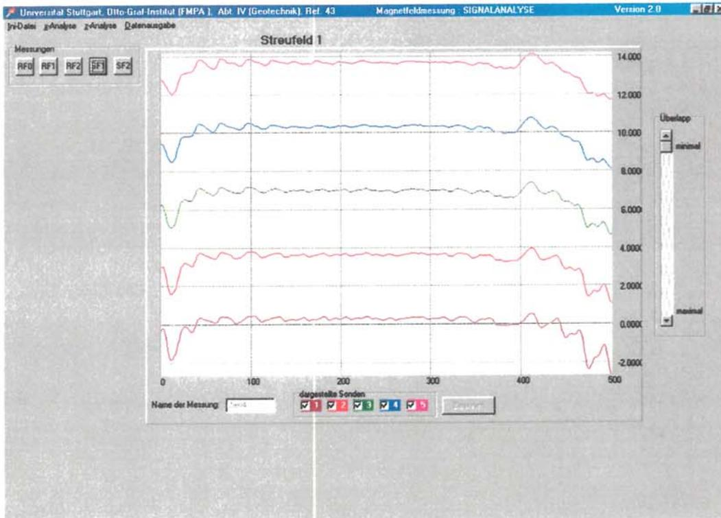
Bild 27: Streufeldverlauf, Messung 2aw4, Messfahrt 19 (Restfeldmessung)
