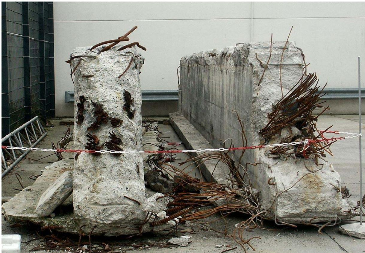
Abb. 4: Trägersegmente, Draufsicht, vorn ehemalige Ankerungsseite
