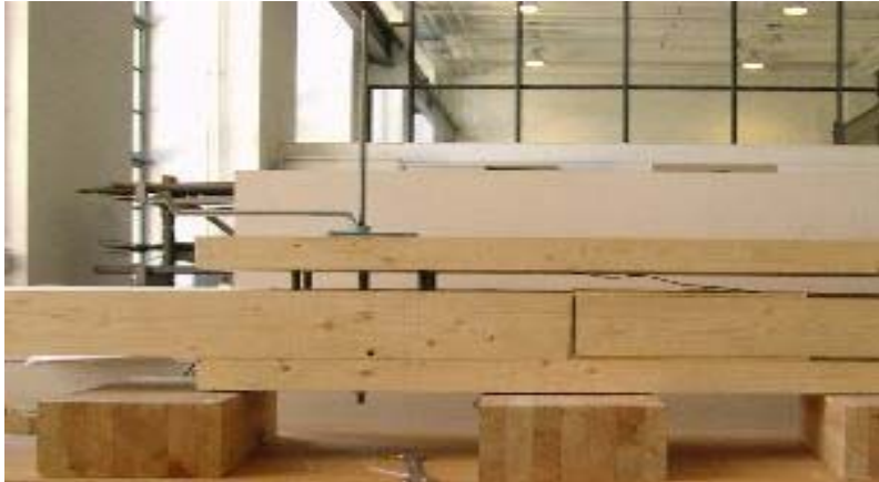
Bild 11: Zusammenbau von Seitenholz C mit dem Mittelholz
