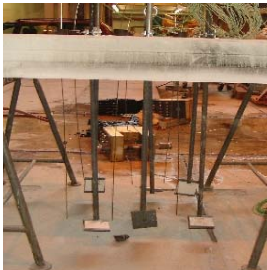
Bild 18: Deckensegment mit Thermoelementen
