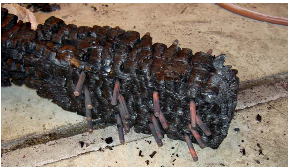
Bild 44: Mittelholz Probekörper Typ III mit Stabdübeln \varnothing 12 mm
