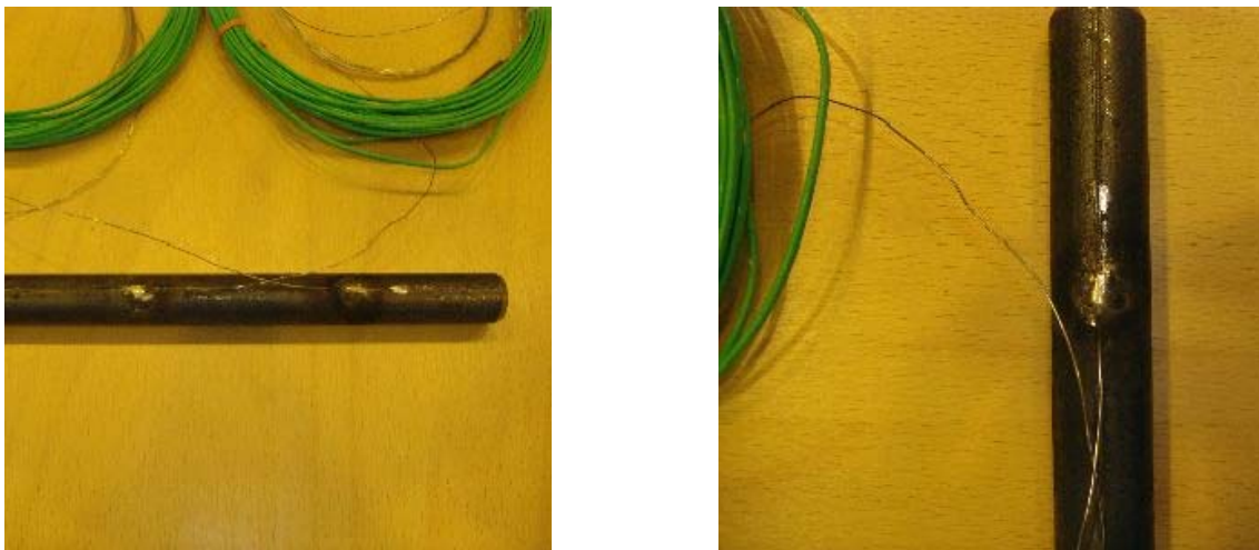
Bild 9: Stabdübel mit angelötetem Thermoelement (links) und eine nachbearbeitete Kontaktstelle (rechts)
