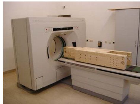
Bild 5: Computer-Tomograph mit Probekörper
