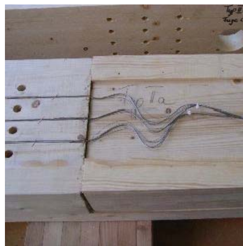
Bild 10: Zusammenbau von Seitenholz A mit dem Mittelholz (links) und Verlegung der Thermodrähte und Füllholz mit Fichtenholzleisten (rechts)
