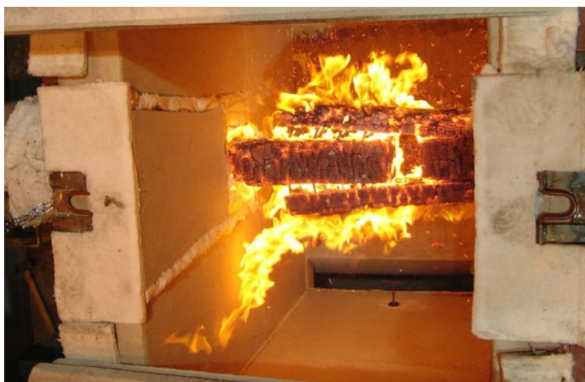
Bild 22: Geöffneter Prüfofen mit Versuchskörper nach Abschluss des Brandversuchs
