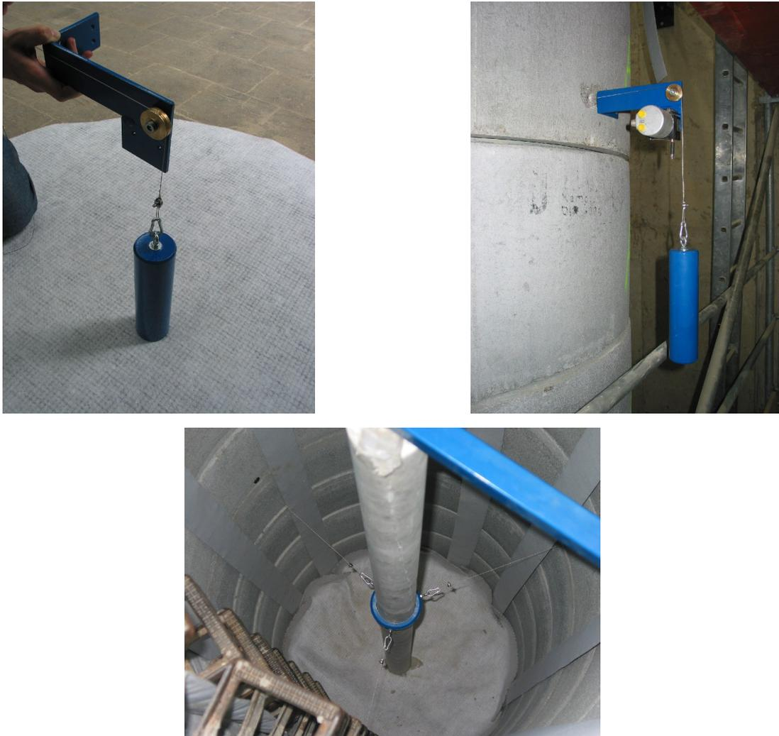
**Abbildung 8.11: Erfassung der seitlichen Verschiebung des Pfahles mit Hilfe von vorgespannten Messdrähten: Methode 1a/b (rechts oben: Umlenkrolle und Gewicht, links oben: Konsole mit Wegsensor am Behälter montiert, unten: Messdrähte im Inneren des Behälters, Methode 1a)**
