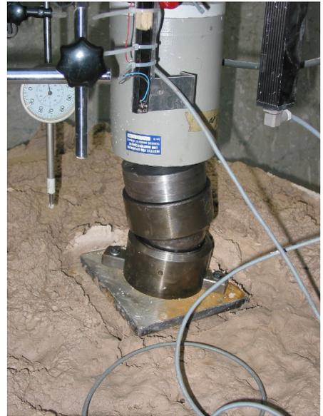
**Abbildung 8.21: oberes Pfahlgelenk nach dem Belastungsversuch**
