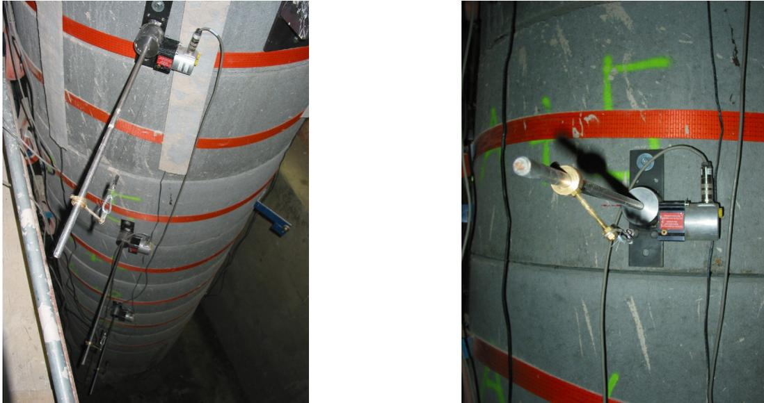
**Abbildung 8.12: Wegaufnahme nach der Methode 2; links: die drei Messebenen entlang der Pfahlachse; rechts: eine Messstelle mit Führungsbüchse, Stange und Seilzugwegaufnehmer**
