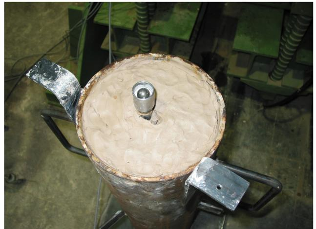
**Abbildung 7.7:** oberes Pfahlaulager (Kugelgelenk) nach einem Belastungsversuch
