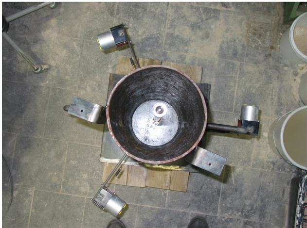
**Abbildung 7.6:** Komplettansicht des Versuchsbehälters mit montierten Seilzugwegaufnehmern von oben
