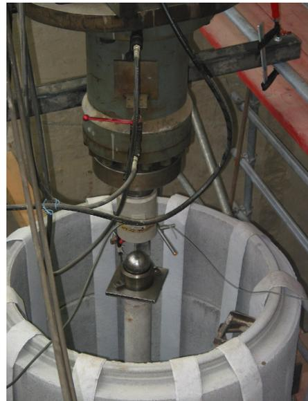
**Abbildung 8.5:** oberes Pfahlaufleger (Pfahl GEWI28, kurz vor der Versuchsdurchführung ohne seitliche Bodenstützung)
