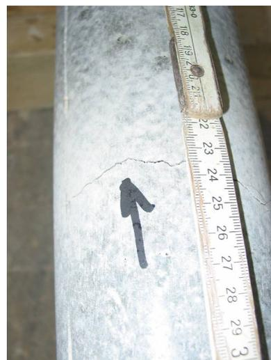
**Abbildung 8.31: Querrisse in den Verbundpfählen für die mit Boden gestützten Probelastungen**
