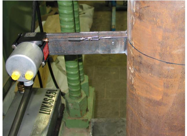
**Abbildung 7.5:** am Behälter befestigter Seilzugwegaufnehmer
