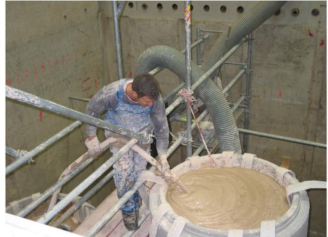
**Abbildung 8.14: Einpumpen des Versuchsbodens in die Behälter**
