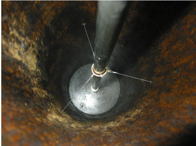
**Abbildung 7.4:** vorgespannte Messseile, in Ausgangslage (Position 0) unter 120°
