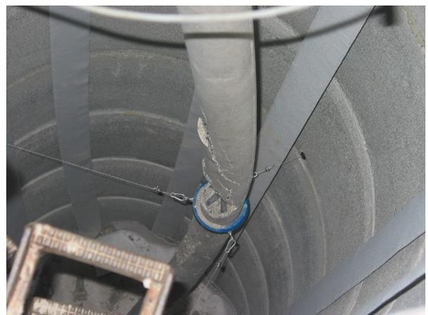
Abbildung 8.17: Pfahl nach Erreichen der Traglast (Versuch 00-GEWI28\_100-03)
