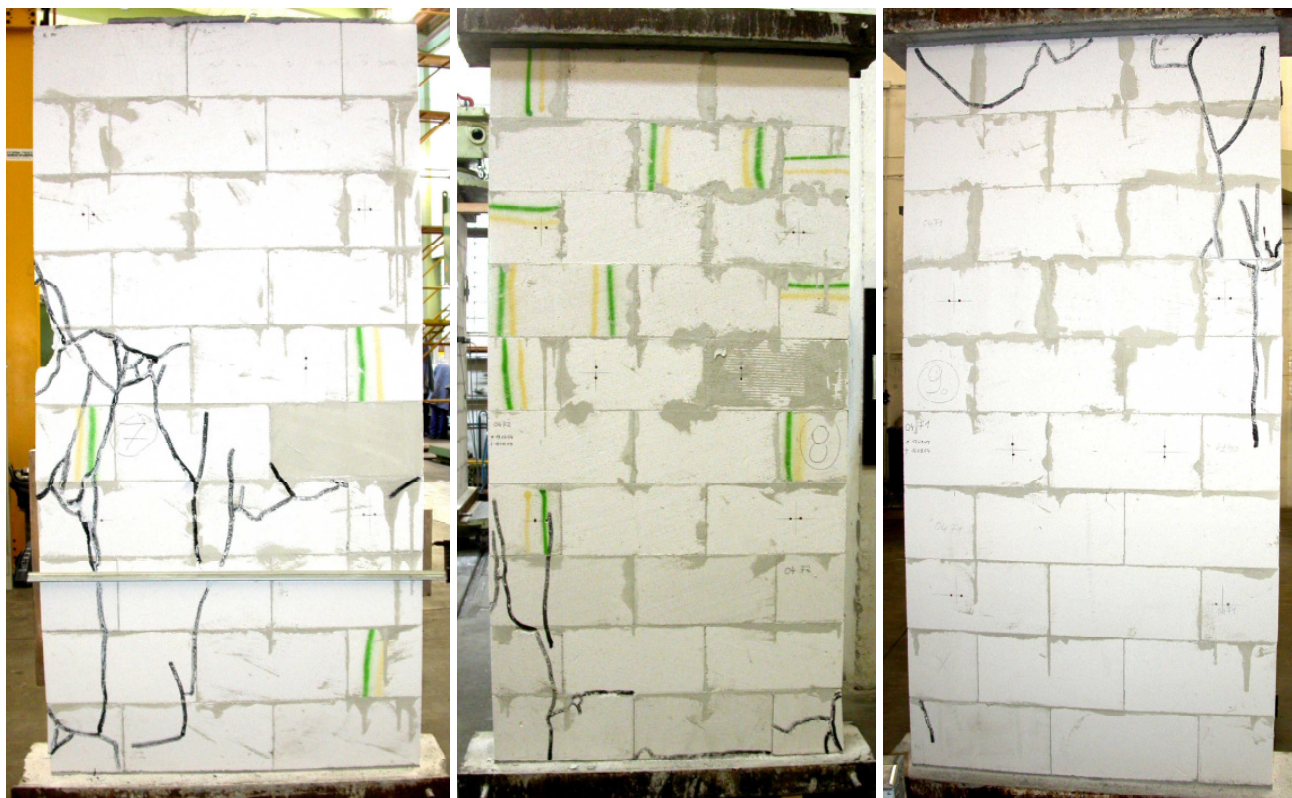
Bild 9: Prüfkörper mit nachgezeichnetem Rissverlauf der Sorte 2-0.4 ohne Griffhilfe
