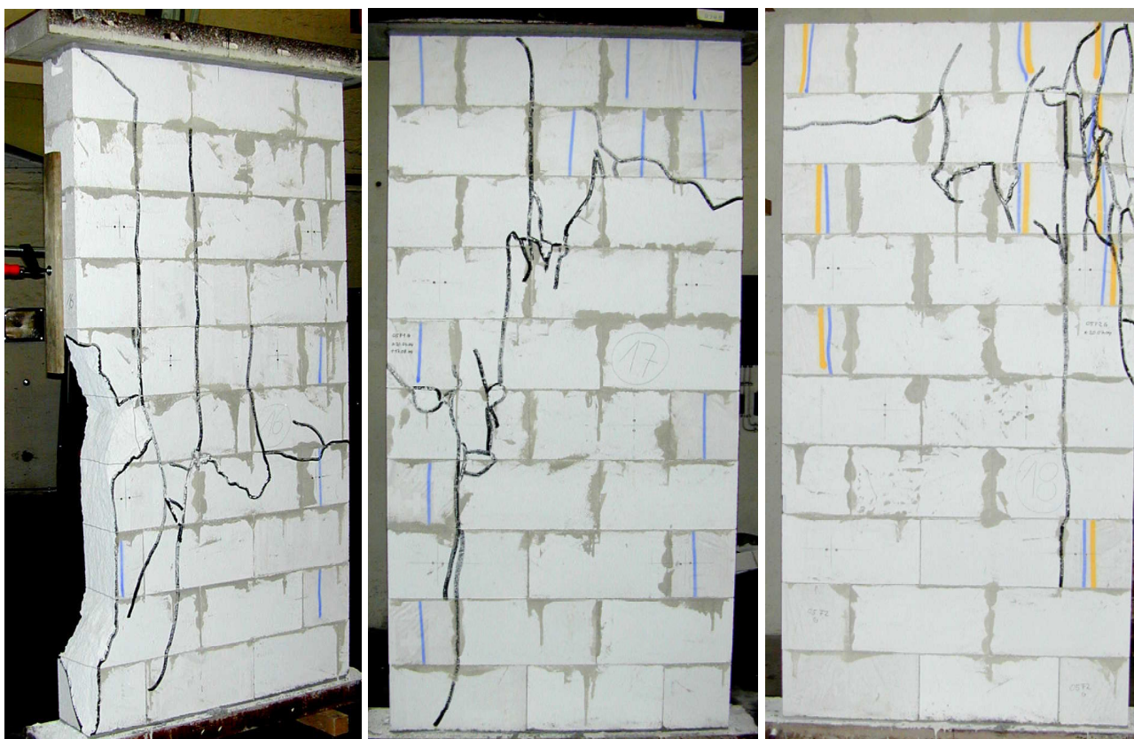
Bild 12: Prüfkörper mit nachgezeichnetem Rissverlauf der Sorte 4-0.5 mit Griffhilfe
