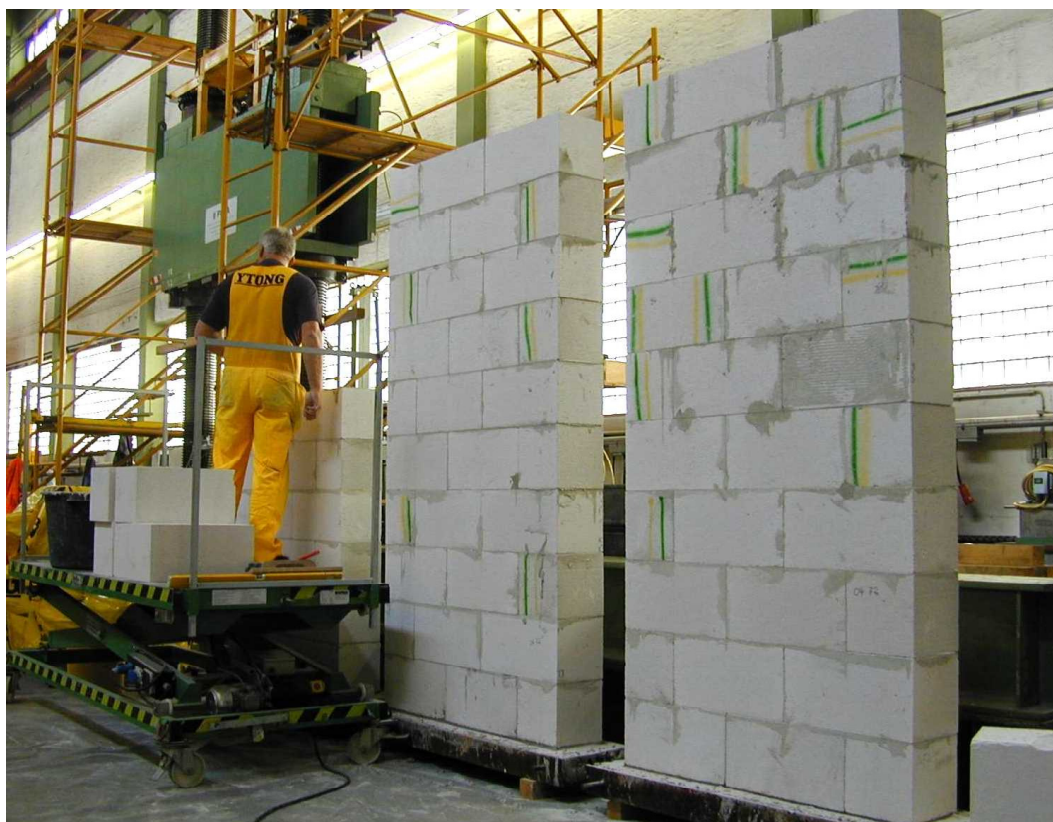
Bild 6: Herstellung der Prüfkörper
