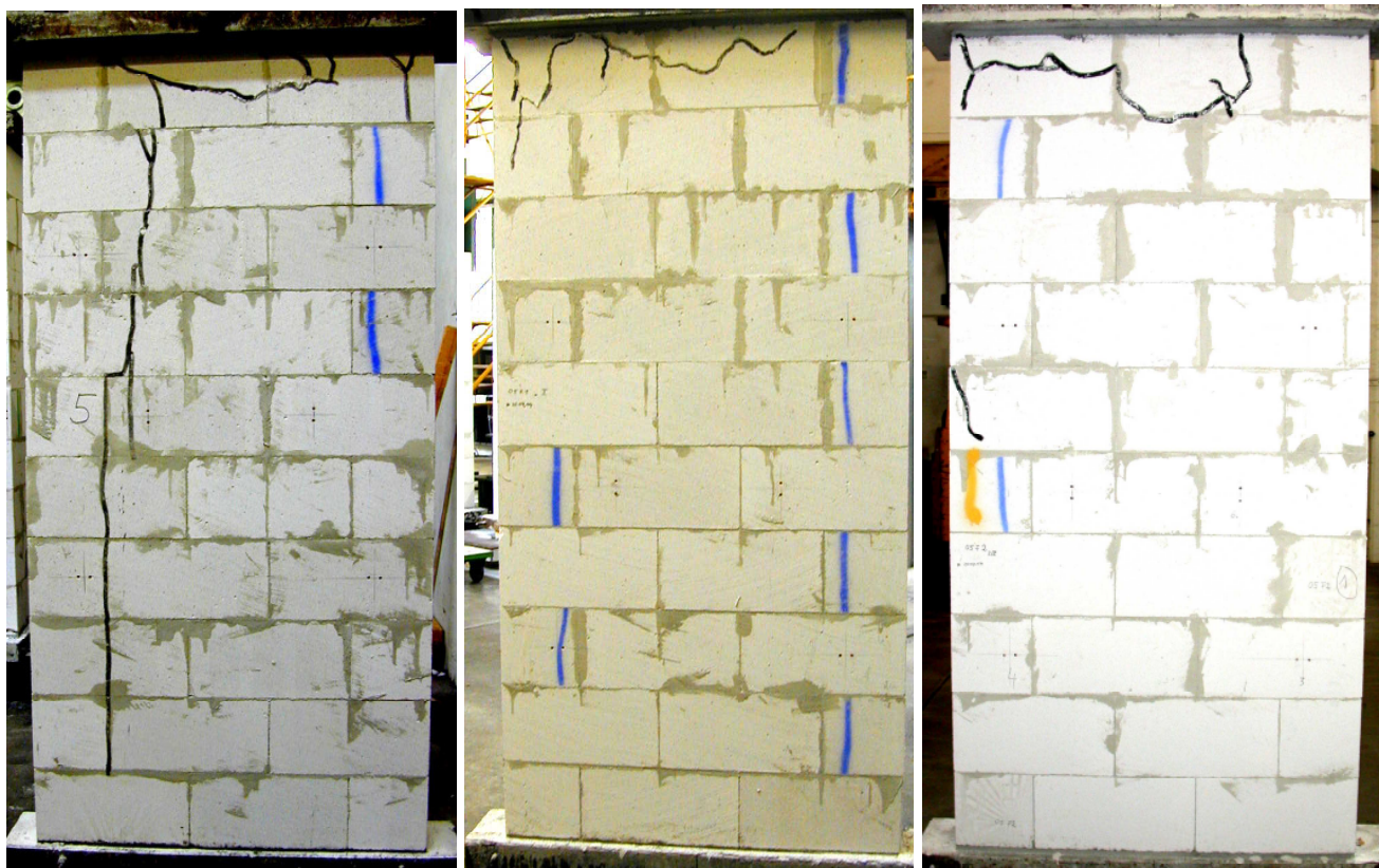
Bild 11: Prüfkörper mit nachgezeichnetem Rissverlauf der Sorte 4-0.5 ohne Griffhilfe
