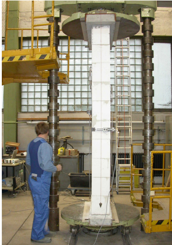
Bild 7: verwendete Druckprüfmaschine mit eingebautem Wandprüfkörper
