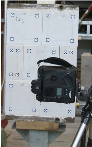
Bild 20 Erfassung der Objektkoordinaten per Digitalkamera
