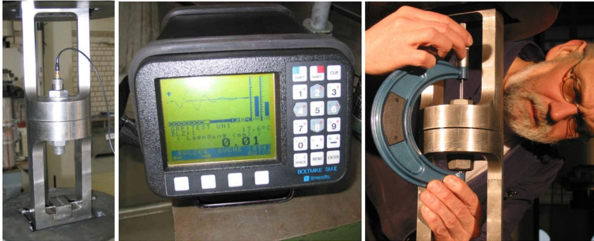
Abbildung 3-5: Messung mit Ultraschallverfahren und Bügelmessschraube
