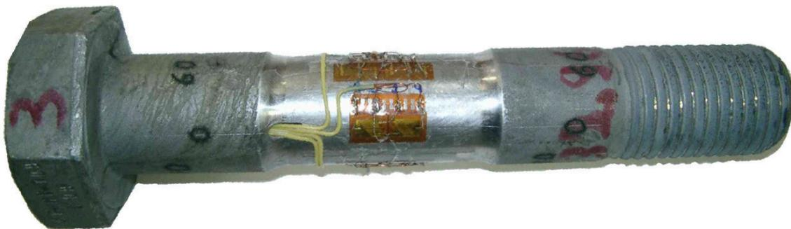
Abbildung 3-1: DMS-Schraube M36 HV zur Messung von Schraubenkraft, Biege- und Torsionsmoment
