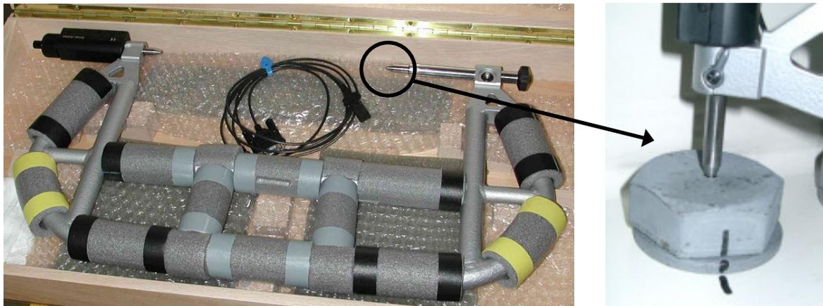
Abbildung 3-8: Verwendete Bügelmessschraube
