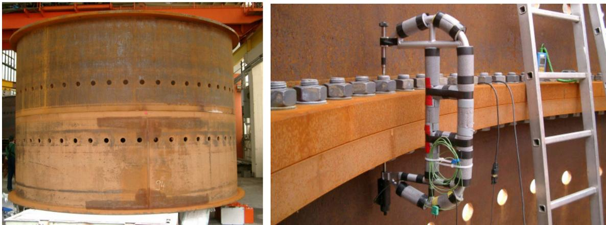
Abbildung 4-26: Verspannte Fundamenteinbauteile
