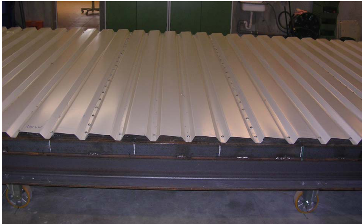
Bild 3: deutliche Blechendverwölbung beim Trapezprofil unter einer Belastung von etwa 150kN
