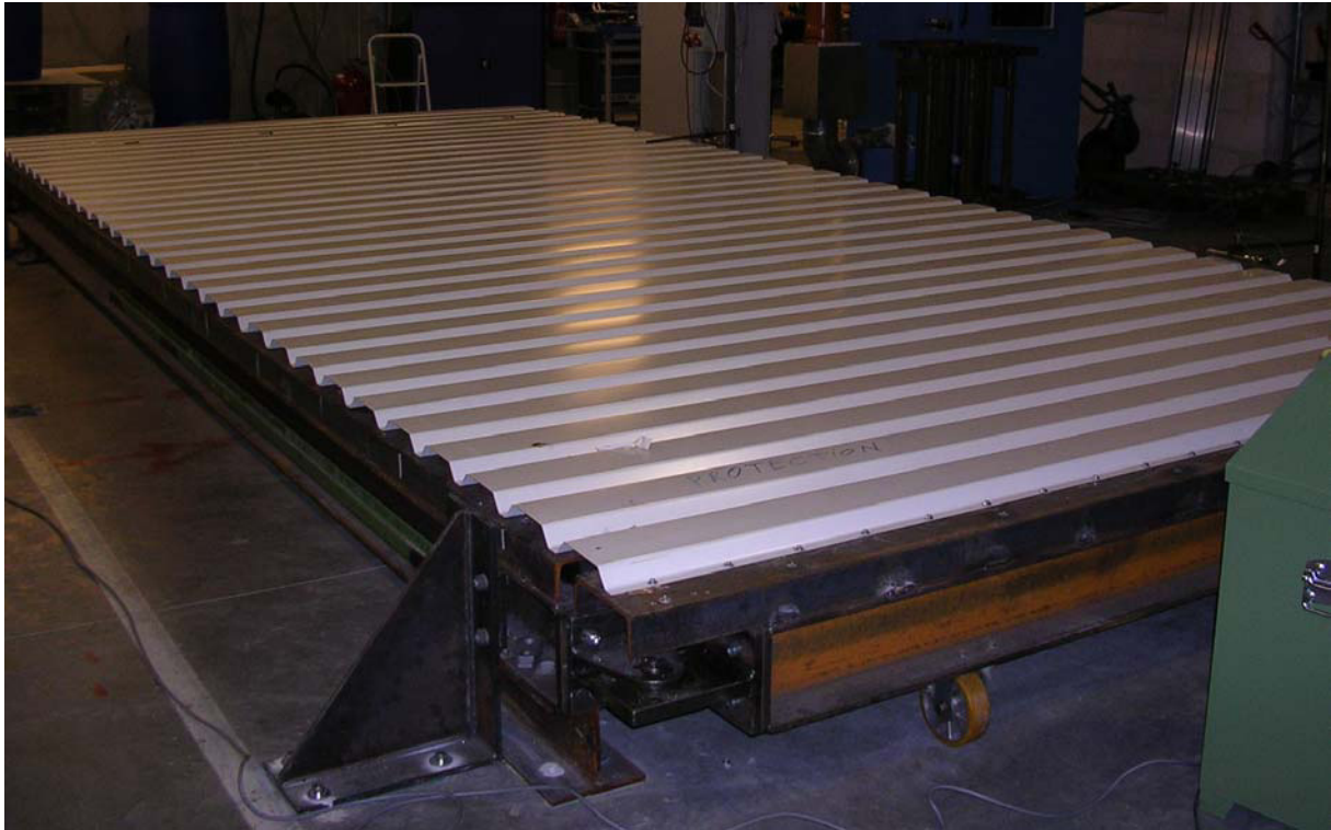
Bild 2: eingedeckter Schubrahmen mit vierseitig gelagertem Trapezblech
