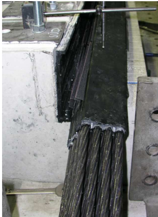
Abbildung 5.3: Extreme Schiefstellung des Spannglieds B VT-CMM D
