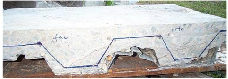
**Bild 3-39** Versagen des Versuchskörpers S-10 [3.1]
