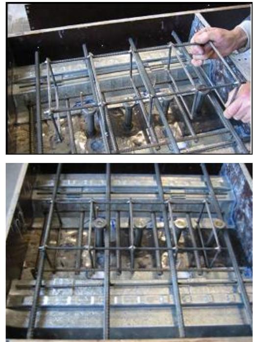
**Bild 3-45** Ansicht und Grundriss des Versuchskörpers P-05 sowie Grundriss kurz vor dem Betonieren [3.1]
