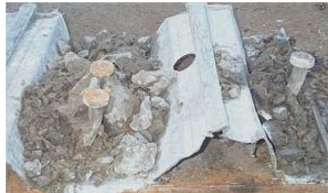
**Bild 3-36** Versagen des Versuchskörpers S-05 durch *Concrete pullout* [3.1]
