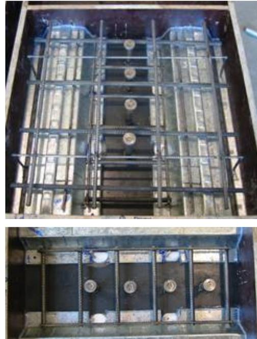
**Bild 3-44** Ansicht und Grundriss des Versuchskörpers P-04 sowie Grundriss kurz vor dem Betonieren [3.1]
