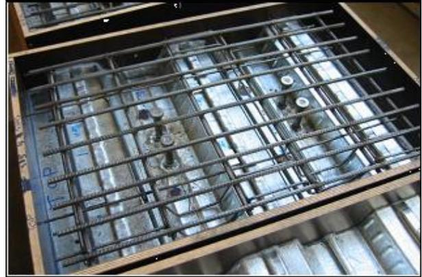
**Bild 3-31** Ansicht des Versuchskörpers S-05 sowie Grundriss kurz vor dem Betonieren [3.1]
