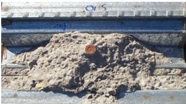
**Bild 3-34a** Versagen des Versuchskörpers S-01 in der Sicke mit exzentrischer Dübelanordnung [3.1]
