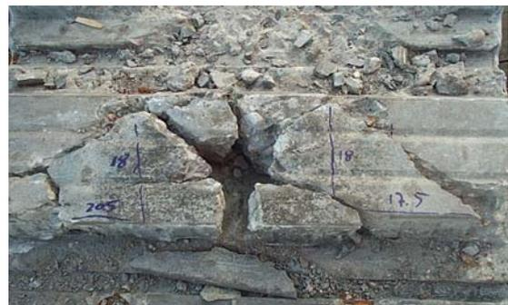
**Bild 3-34b** Versagen des Versuchskörpers S-01 in der Sicke mit zentrischer Dübelanordnung [3.1]
