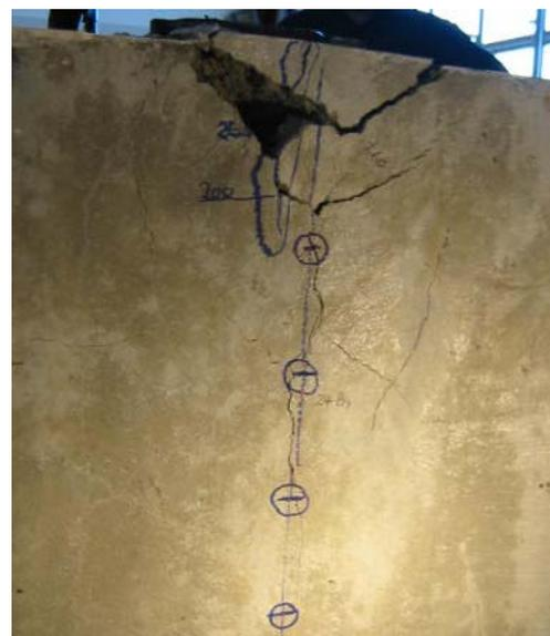
**Bild 3-48** Versagen des Versuchskörpers P-03 durch Spalten des Betons [3.1]
