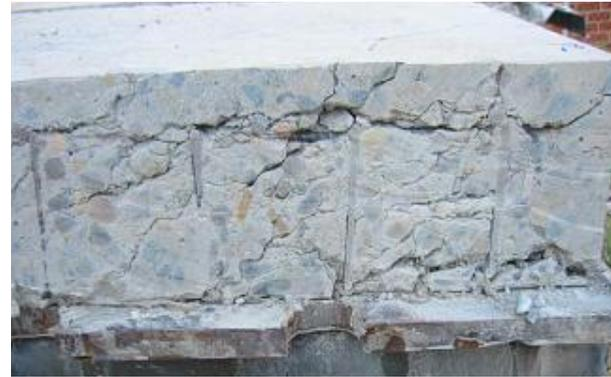
**Bild 3-50** Rissbildung in der Sicke des Versuchskörpers P-05 [3.1]
