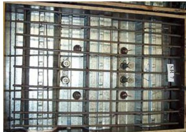
**Bild 3-32** Ansicht des Versuchskörpers S-07, Bewehrung der Sicken sowie Grundriss kurz vor dem Betonieren [3.1]
