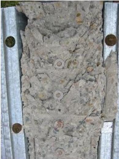
**Bild 3-49** Versagen des Versuchskörpers P-04 durch Abscheren der Rippe [3.1]
