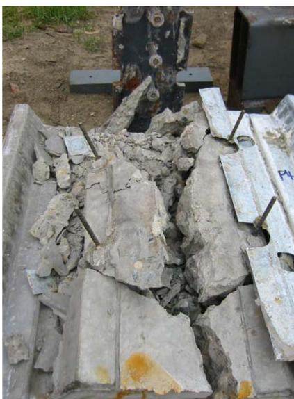
**Bild 3-47** Versagen des Versuchskörpers P-02 durch Spalten des Betons [3.1]
