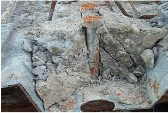
**Bild 3-38** kombiniertes Versagen des Versuchskörpers S-07 [3.1]
