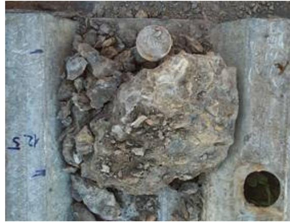
**Bild 3-35** Versagen des Versuchskörpers S-02 in der Sicke mit exzentrischer Dübelanordnung [3.1]
