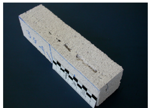
Bild 9: Gärschatten in einem Probekörper für die Biegezugprüfung
