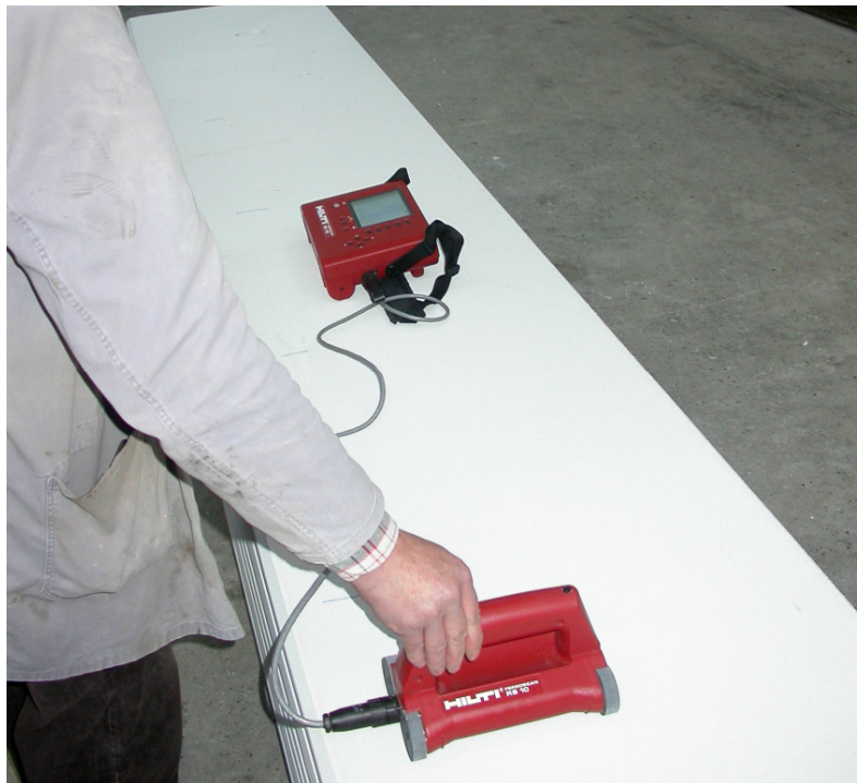
Bild 2: Zerstörungsfreie Ermittlung der Bewehrungslage im Bauteil
