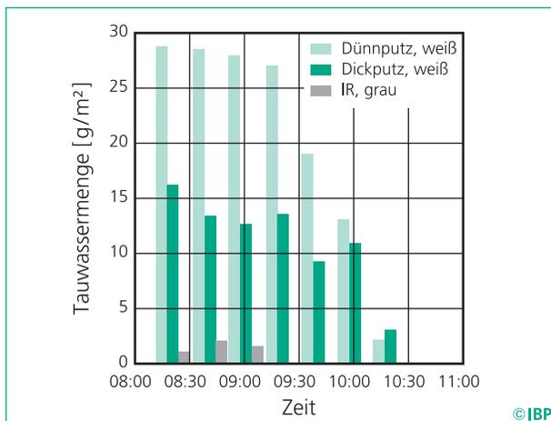
Bild 3: Verläufe der Oberflächenfeuchte für westorientierte Wände mit verschiedenen WDV.
