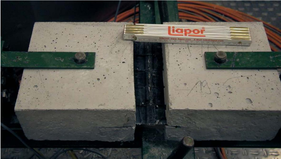
Abbildung 9-9: Geschweißte Parallelfuge während der Versagensprüfung bei einem Dehnweg von ca. 50 mm (PK 18.4 TPE, +20°C)
