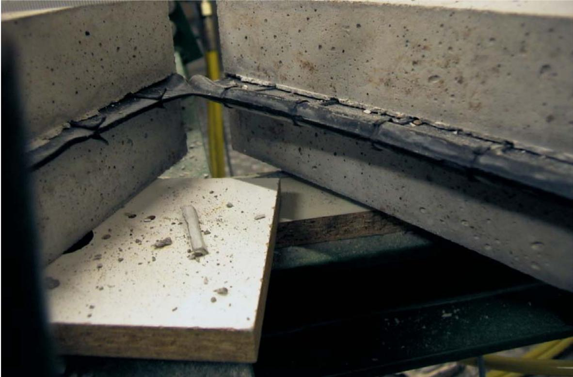
Abbildung 9-11: Versagen neben dem Mittelschlauch bei einem Dehnweg von ca. 90 mm (PK 18.5, TPE, +20°C)
