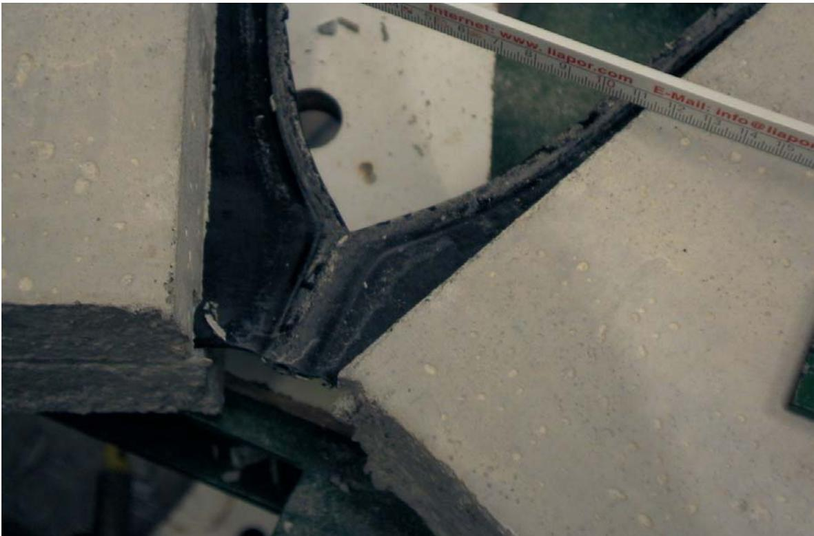
Abbildung 9-10: Versagen im Mittelschlauch bei einem Dehnweg von ca. 95 mm (PK 19.4, TPE, +20°C)
