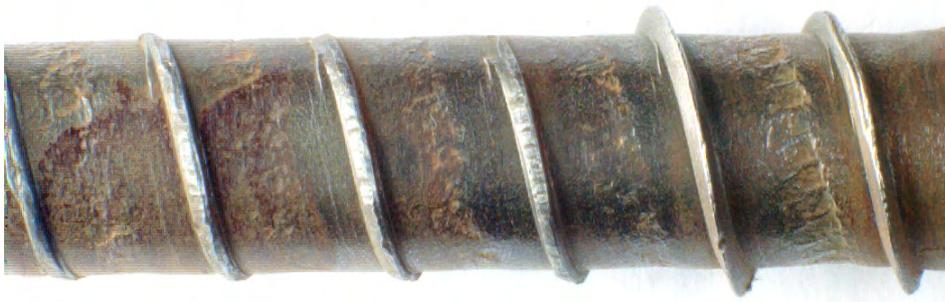
**Abb. 5:** Versagen einer Schraube durch Abscheren des Gewindes im CUAP-Test
