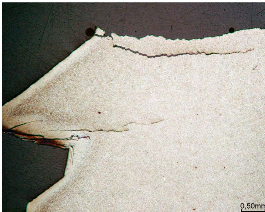
**Abb. 26:** Längsschliff unterhalb der Bruchfläche mit Nebenrisse
