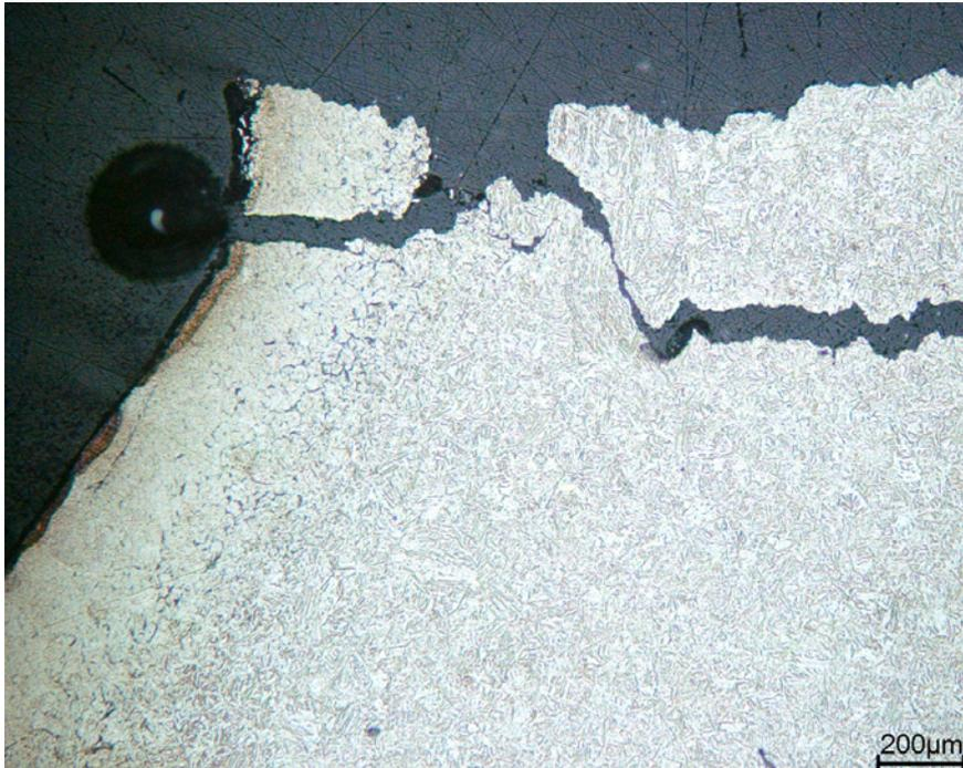
**Abb. 27:** Detail aus Bild 26 (links Härtezone – geätzt mit alk.  $\text{HNO}_3$ )
