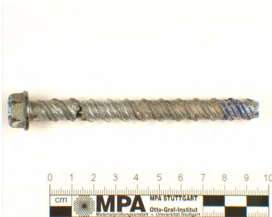
**Abb. 19:** Im Test gebrochene Schraube (Standzeit 37,7 h , Prüfung in Beton bei  $-1000$  mV)
