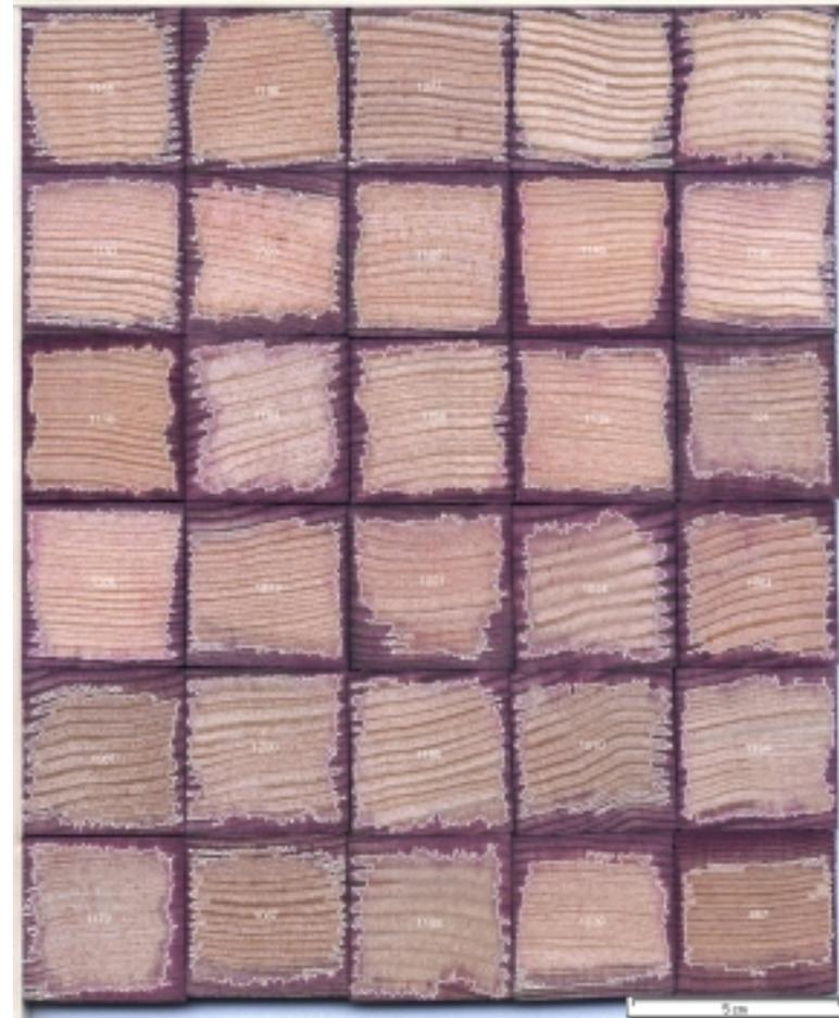
Abbildung A 2: Eindringung eines **chromfreien** Holzschutzmittels in Abhängigkeit von der Trocknungsart (Z: 1 + 2 = FT, Z: 3 + 4 = 55°C und Z: 5 + 6 = 75°C) an Messstelle 2 – **LINKS: ohne Farbnachweis und RECHTS: nach Farbnachweis einschließlich Auswertung mittels Bildanalyse**
