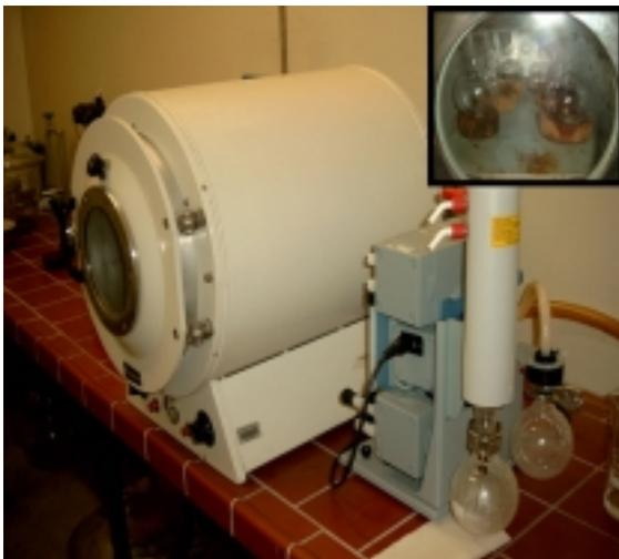
**Abbildung 4:** Vakuumtrockenschrank (Oben rechts: Blick auf die Extraktmittel in den Kolben)
