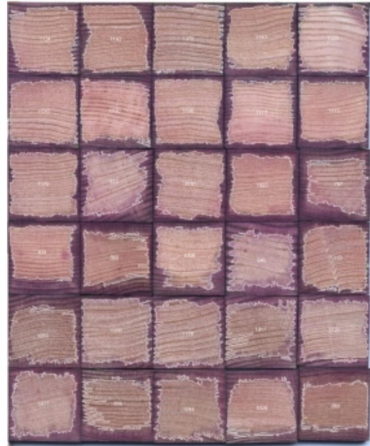
Abbildung A 3: Eindringung eines **chromfreien** Holzschutzmittels in Abhängigkeit von der Trocknungsart (Z: 1 + 2 = FT, Z: 3 + 4 = 55°C und Z: 5 + 6 = 75°C) an Messstelle 3 – **LINKS: ohne Farbnachweis und RECHTS: nach Farbnachweis einschließlich Auswertung mittels Bildanalyse**
