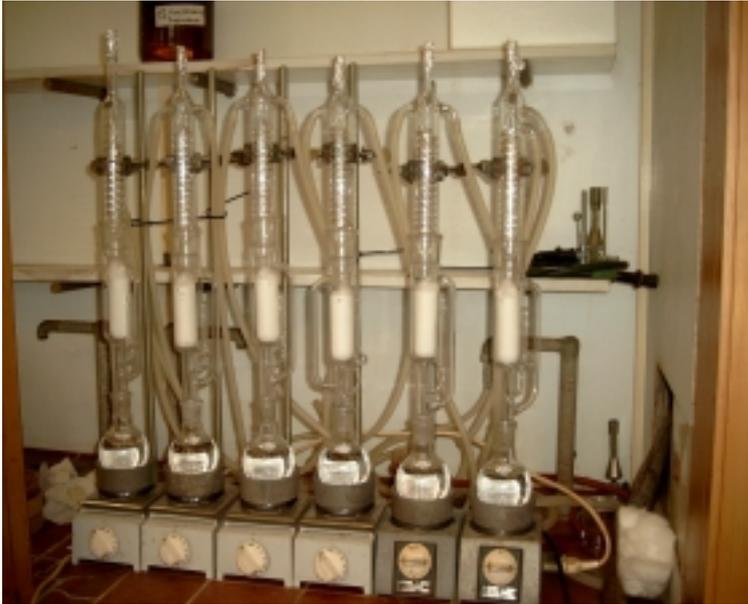
**Abbildung 3:** Soxhlet-Extraktor-Batterie bestehend aus sechs Soxhlet-Extraktoren
