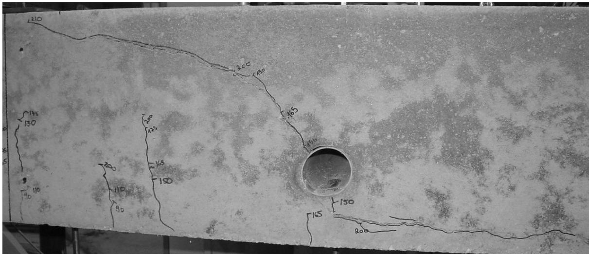
Abbildung 10-17: Versuch T6\_70\_unten
