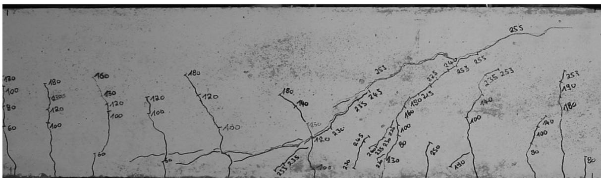
Abbildung 10-6: Versuch T13\_ohne Öffnung h=25 cm
