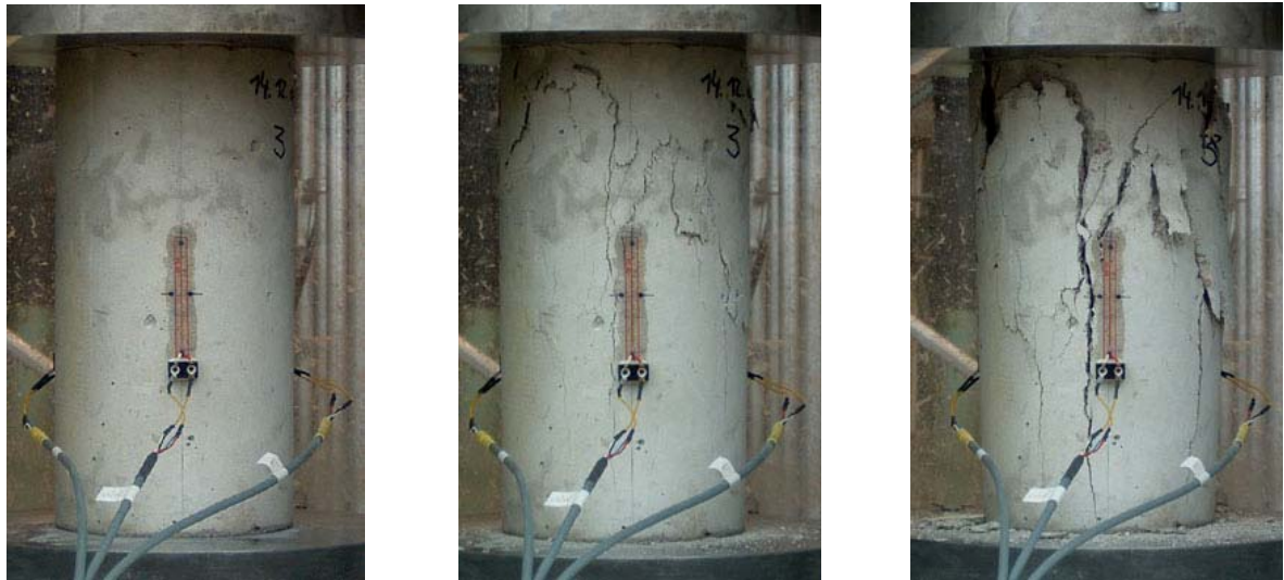
Bild 14 Betonprüfkörper bei der Ermittlung der Spannungs-Dehnungs-Kennlinie
