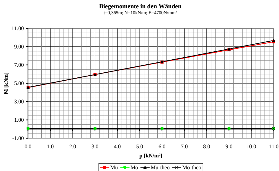
Bild 60 Gegenüberstellung der Wandbiegemomente nach FEM-Berechnung und theoretischem Modell gemäß Abschnitt 5 bei einer Auflast von 10 kN/m
