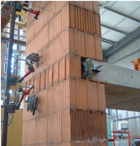
Bild 15 Induktive Wegaufnehmer in der Wandachse und Neigungsmessgeräte im Knotenbereich
