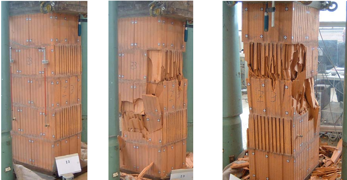
Bild 13 Druckfestigkeitsprüfung nach DIN EN 1052-1 [8]
