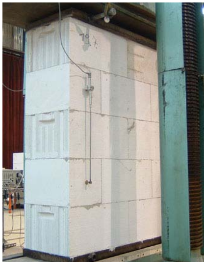
Bild 22 Druckfestigkeitsprüfung nach DIN EN 1052-1 [8]
