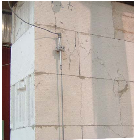
Bild 22 Druckfestigkeitsprüfung nach DIN EN 1052-1 [8]
