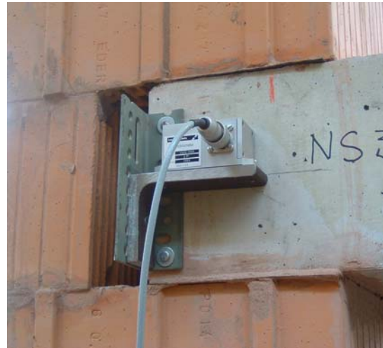
Bild 15 Induktive Wegaufnehmer in der Wandachse und Neigungsmessgeräte im Knotenbereich
