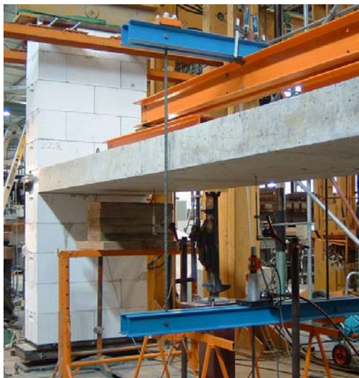
Bild 18 Außenwand-Decken-Knoten aus Porenbetonmauerwerk im Originalmaßstab
