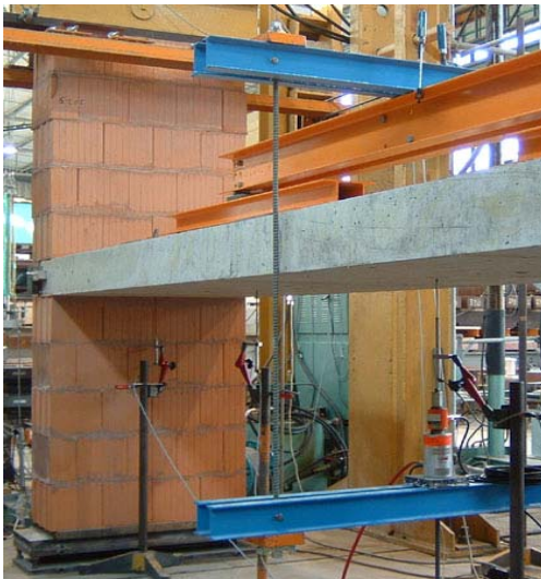
Bild 9 Außenwand-Decken-Knoten aus Ziegelmauerwerk im Originalmaßstab
