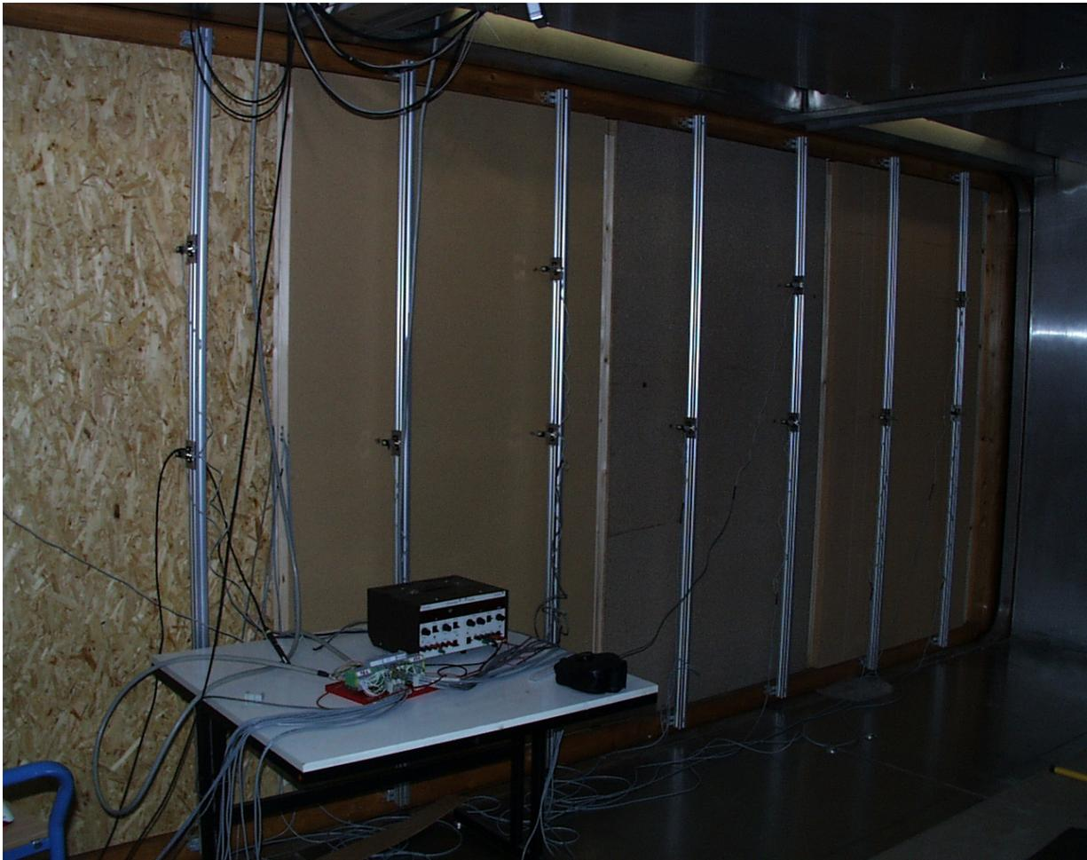
**Abbildung 7: Ansicht der Warmkammerseite mit den Aluminiumprofilen zur Aufnahme der Wegmesstechnik**
