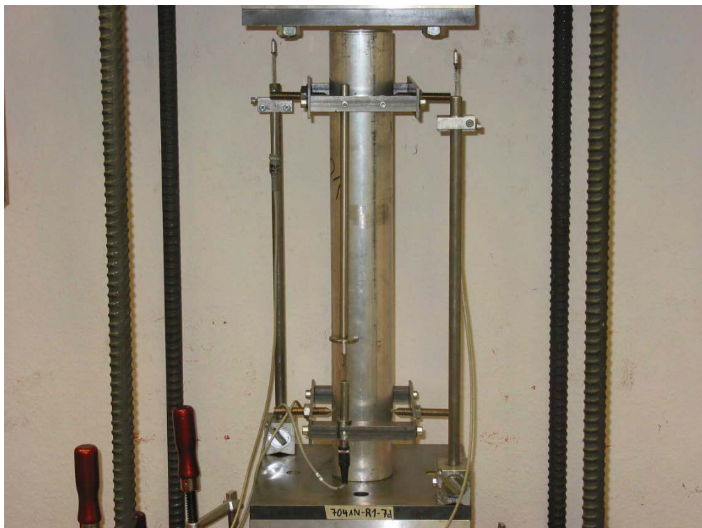
Bild 9: Stauchversuch am Ausgangsrohr der Spindel, Probenlänge 7 \cdot d
