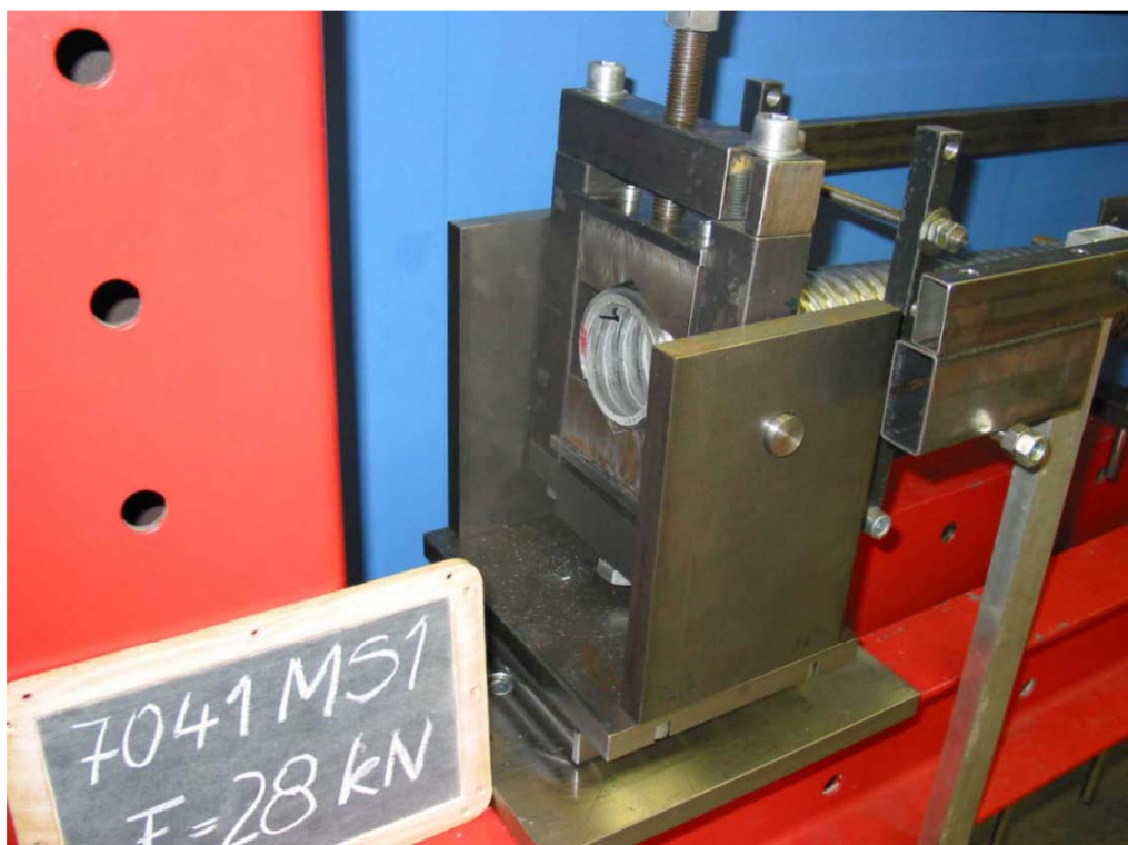
Bild 11: Detail der Auflagerung der Spindel in der Schwerachse, Verdrehung der Wippe infolge Endverdrehung der Spindel
