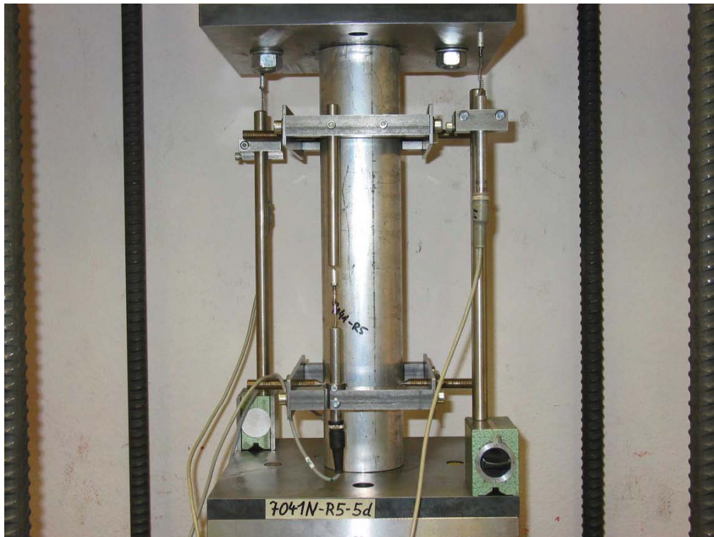
Bild 8: Stauchversuch am Ausgangsrohr der Spindel, Probenlänge 5 \cdot d
