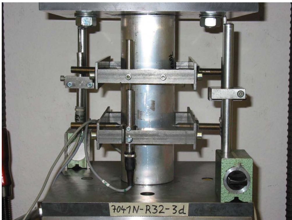
Bild 7: Stauchversuch am Ausgangsrohr der Spindel, Probenlänge 3 \cdot d
