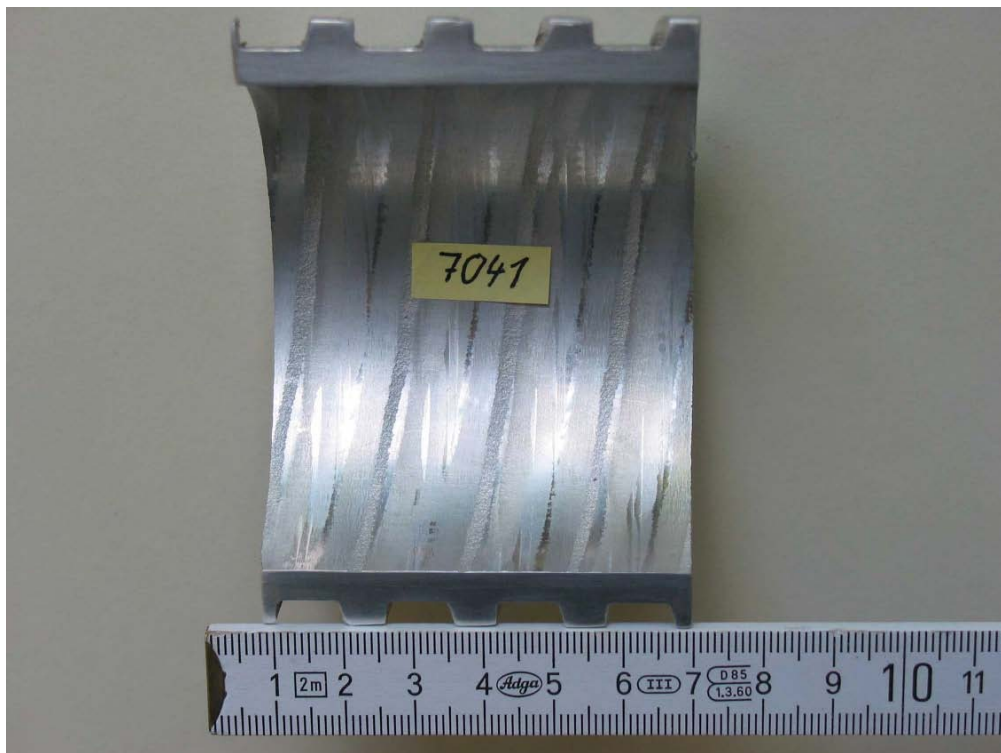
Bild 6: Schnitt durch die NOEprop-Spindel
