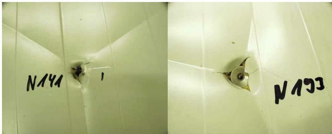
Abbildung 3.9: Versagensbild bei Scheibendurchmesser 14mm (links) und 19mm (rechts)
