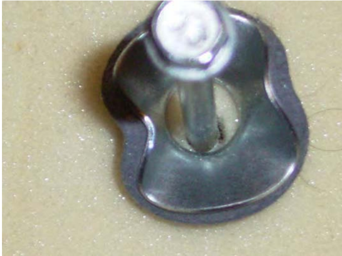
Abbildung 3.1: Scheibe \varnothing_s 29mm nach dem Versagen durch Durchknöpfen
