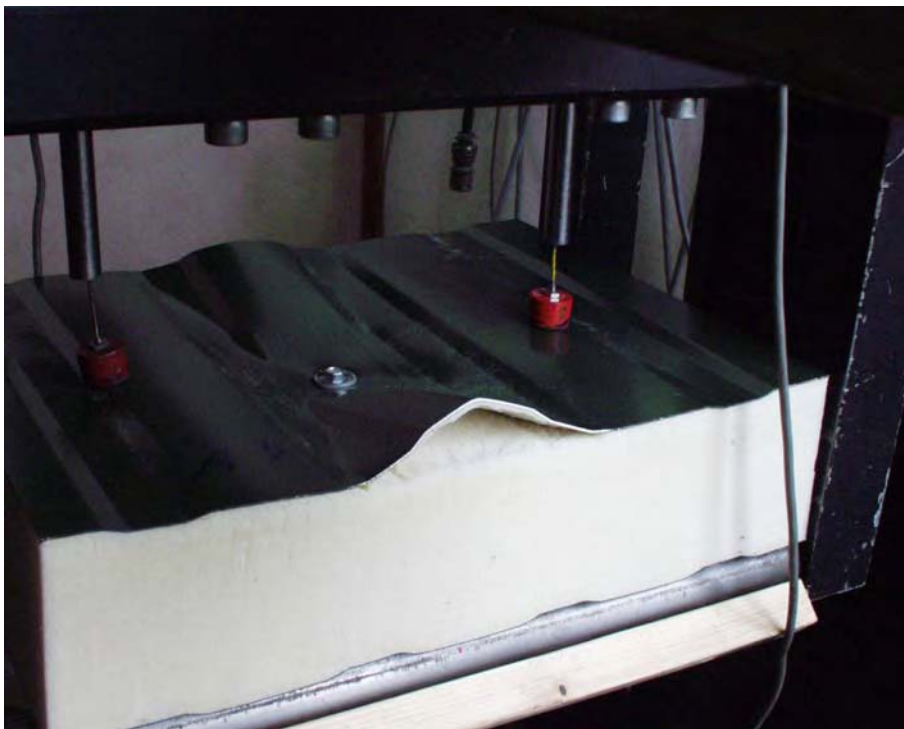
Abbildung 3.2: Abreißen der Deckschichten
