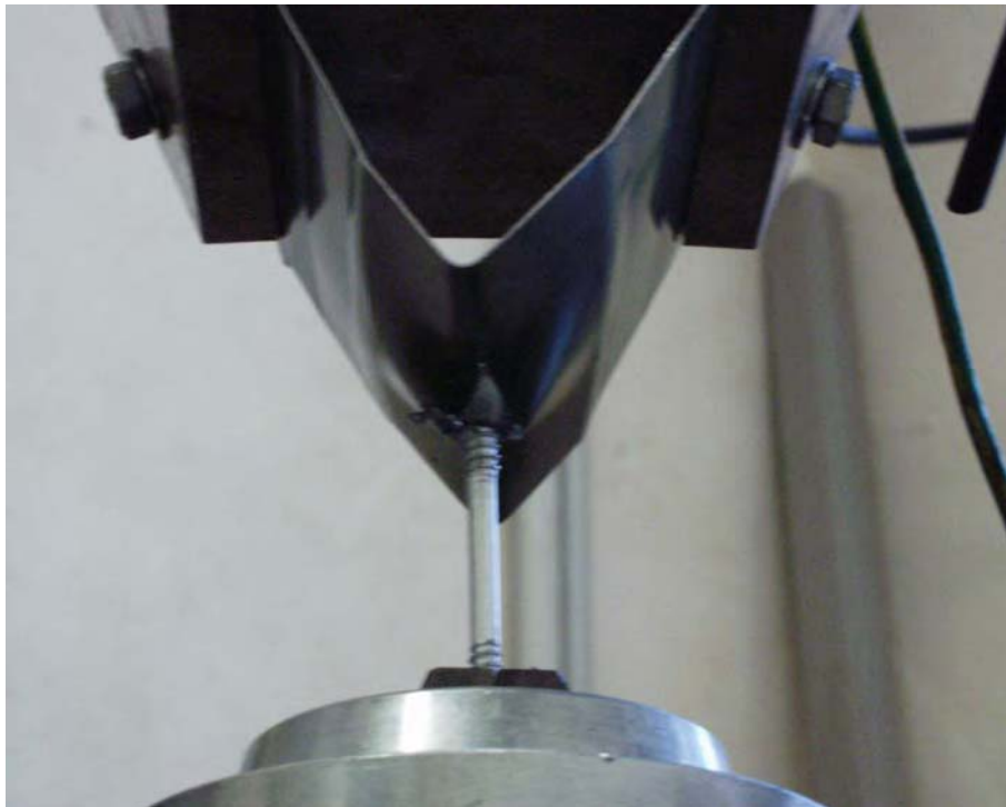
Abbildung 3.5: Versagen durch Rissbildung und Durchknöpfen
