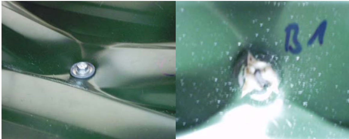
Abbildung 3.3: Versagen durch Durchknöpfen
