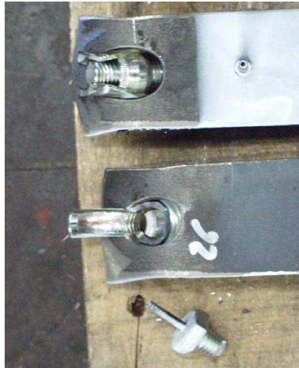
**Abbildung 15: Versagen durch Lochleibung und Herausziehen bei Stahlbaudübeln M12 ohne Gummi bei Klemmdicke  $t = 2 \times 3 \text{mm}$  (Versuch 23, links) und  $t = 2 \times 8 \text{mm}$  (Versuch 26, rechts).**
