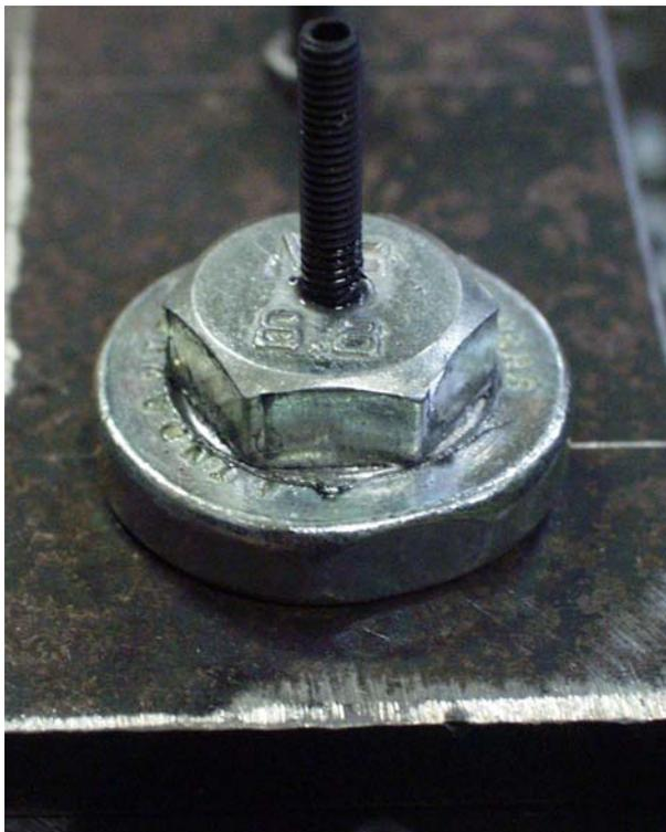
**Abbildung 2: Unterschiedliche Hülsenausbildung bei Stahlbaudübeln M12: zu geringe Auflagefläche bei Länge 1.**
