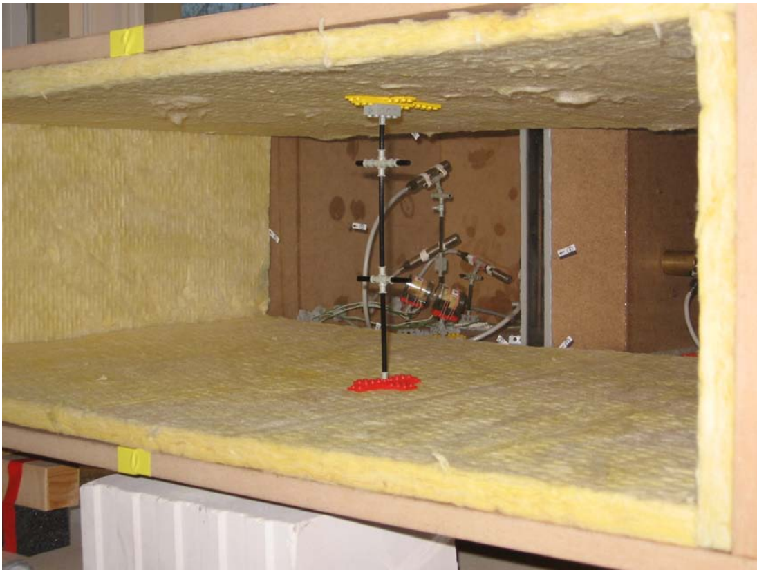
Bild 5 Photo des Rückraums; ohne Rückwand hinter dem Prüfobjekt; mit Dämmmaterial-Auslegung in Anordnung ULRO gemäß Tabelle 1; die Stütze wurde zum Fixieren der Dämmschicht an der Decke eingesetzt und verblieb auch so während der Messung
