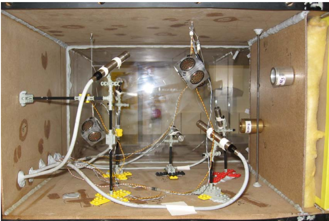
Bild 7 Photo mit Blick in den Senderaum mit Aufbau der Mikrophone und Lautsprecher
