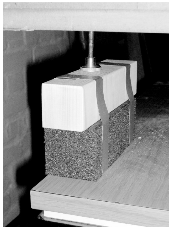
Bild 3 Photo eines Standfußes des Modellprüfstands; von oben: Prüfstand, Gewindestange, Holzklötz, Schaumstoffquader, Tischfläche
