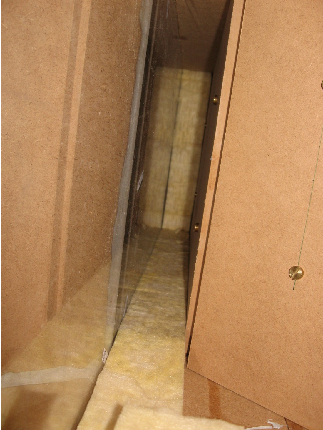
Bild 6 Photo mit Blick in den Rückraum mit Rückwand und Dämmmaterial-Auslegung; unten und im Hintergrund angeordnete Absorber, links die spiegelnde Acrylglaswand, rechts die teilweise geöffnete Rückwand
