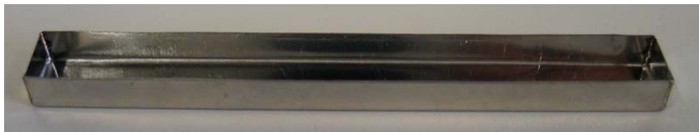
Bild 9: Prüfstückhalter für textile Bodenbeläge, zur Verfügung gestellt vom Deutschen Textil- und Teppichforschungsinstitut e. V.
