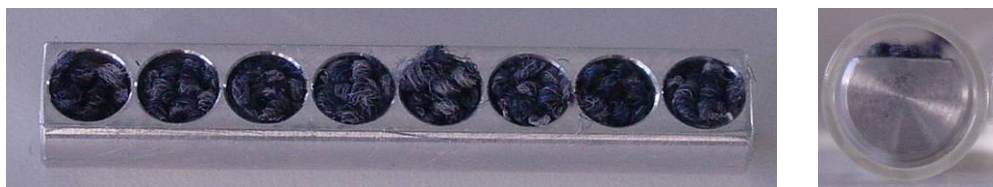
Bild 7: Prüfstückhalter aus Edelstahl (Modell IBP) für textile Bodenbeläge; mit ausgestanzten Prüfstückscheiben.
