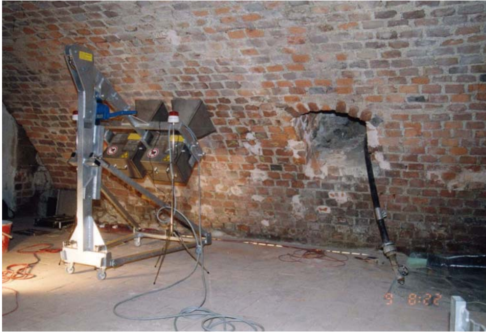
Abb. 6: Positionierung der Mikrowellengeräte am Heizabschnitt 1.
