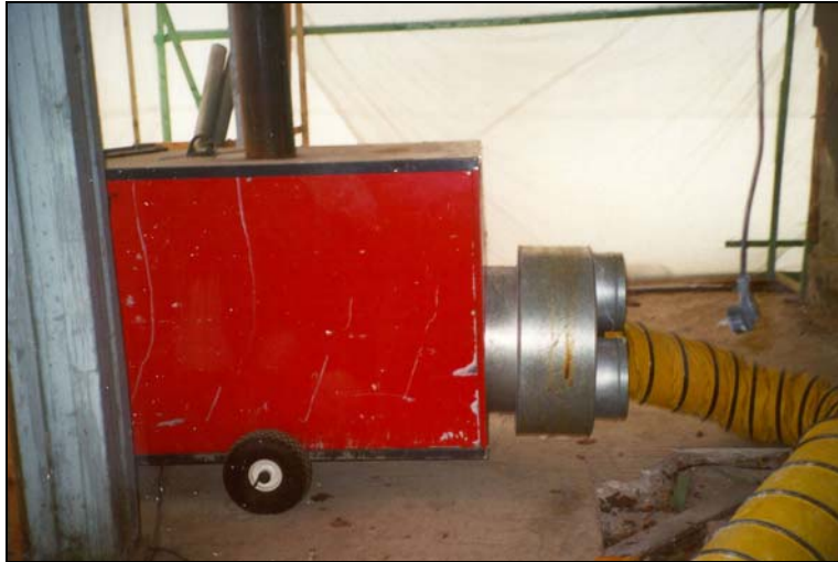
Abb. 7: Modifiziertes Trocknungsgerät für die Direktbeheizung im Umluftverfahren.
