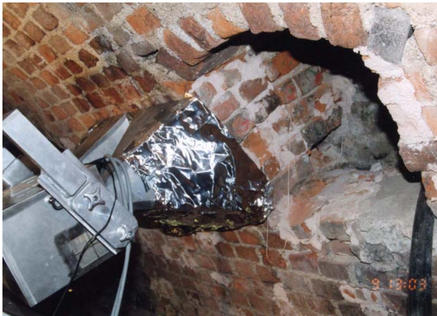
Abb. 7: Anordnung der Strahler in Heizabschnitt 3 mit Bohrlöchern für die Hauschwamm- und Hausbockkäfer-Prüfkörper.
