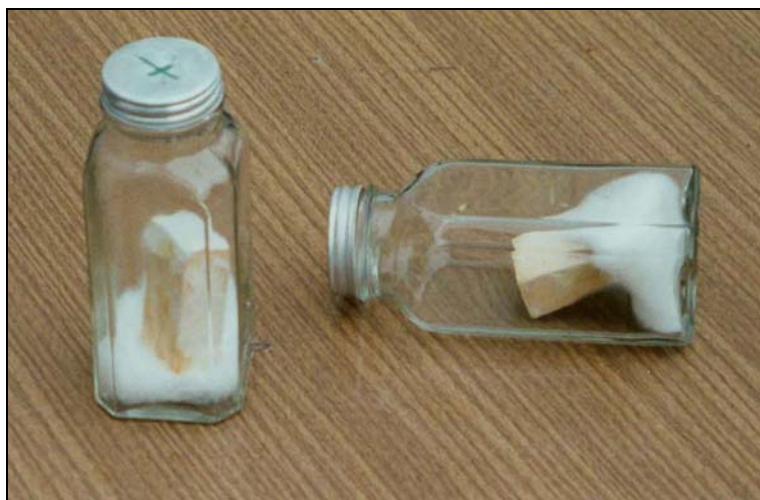
Abb. 8: Prüfkörper mit pilzbewachsenen Kiefernklötzchen.
