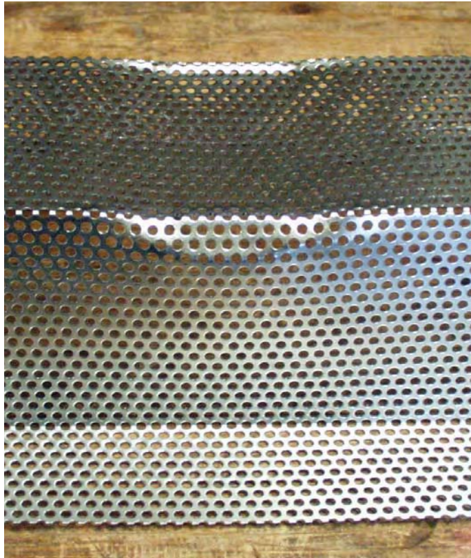
Abbildung B.2.8: Vollperforierter Versuchskörper der Geometrie V nach dem Versuch Zwischenaufleger unter Auflast
