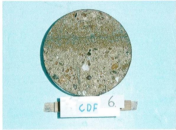
Abbildung 26: Bohrkern im Bereich der Wasserwechselzone (CDF-Verfahren)
