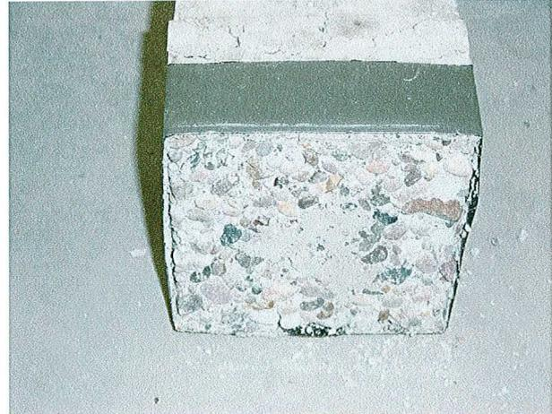
Abbildung 19: Abgewitterte Oberfläche des Fenderbetons
