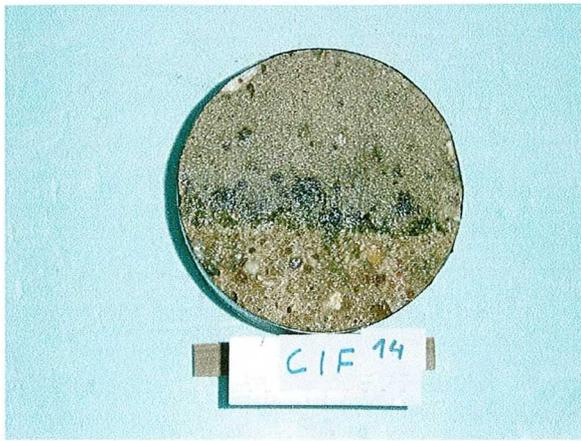
Abbildung 25: Bohrkern im Bereich der Wasserwechselzone (CIF-Verfahren)
