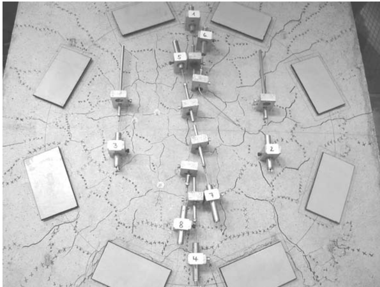
Bild 16: Anordnung der Wegaufnehmer auf der Zugseite
