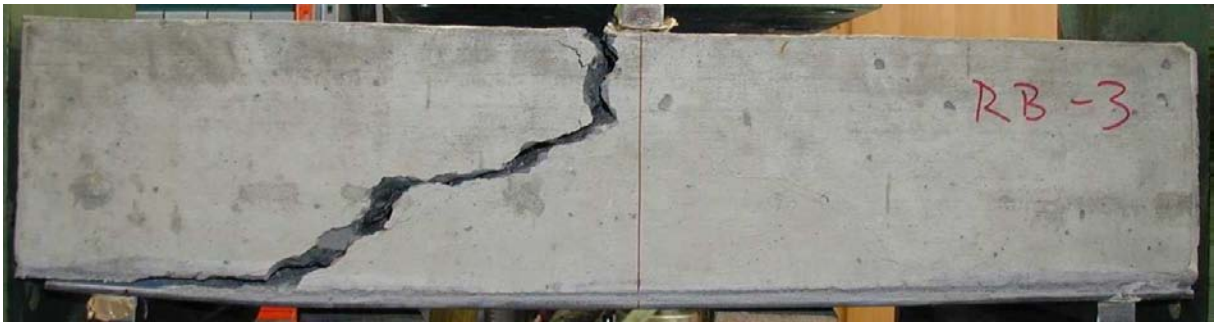
Bild 60: Rissbild eines Versuchskörpers nach dem Schubversuch
