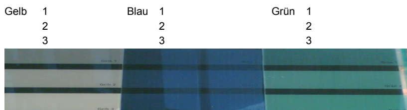
Abbildung 19 Vergleich der Leistungsverluste verschieden farbiger Module mit einem schwarzen Referenzmodul
