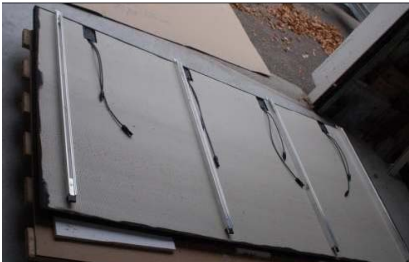
Abbildung 27 Fassadenelement aus vier farbigen PV-Modulen vor der Bewitterung nach ETAG-Zyklus 004 Unterkonstruktion: T-Profilen (vertikal) und Laschenprofile aus Aluminium
