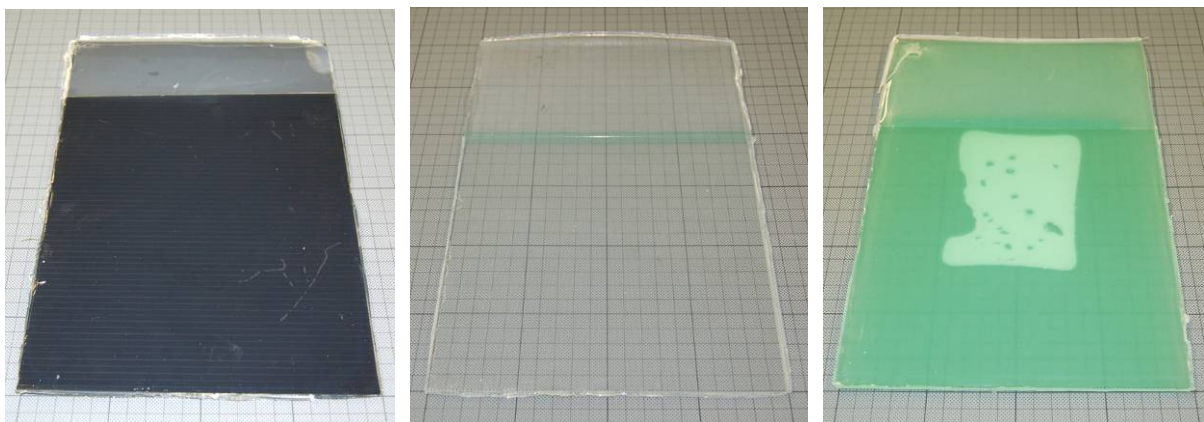
Abbildung 25 Probekörper Floatglas mit CIS-Beschichtung, ohne Beschichtung und mit farbiger Beschichtung
