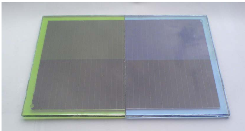
Abbildung 11 Zwei Modulmuster mit flächig laminiertem farbigem Deckglas. Die im Bild jeweils obere Hälfte ist mit einer höherbrechenden Zinkoxidschicht beschichtet. Dort ist die Farbe des Deckglases gut wahrzunehmen.
