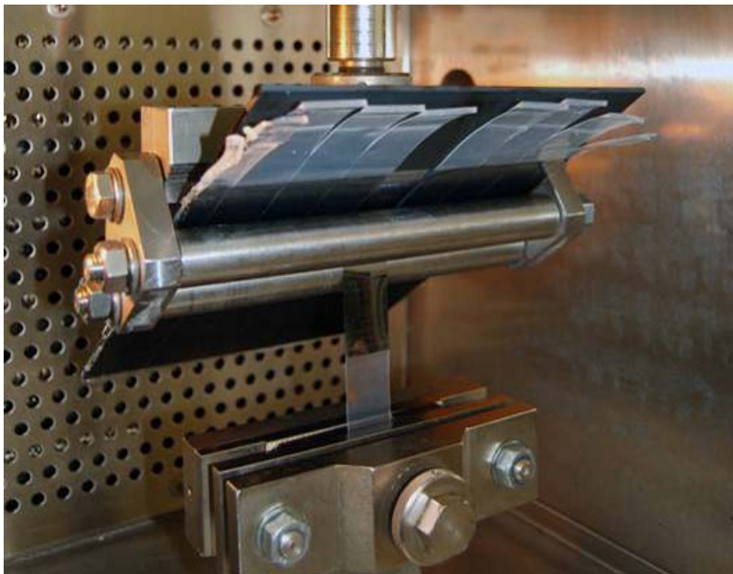
Abbildung 26 Probekörper mit eingeschnittener Folie in der Temperierkammer der Universalprüfmaschine
