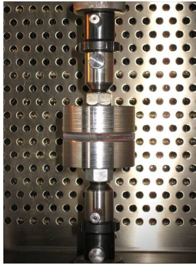
Abbildung 23 Vorbereiteter Probekörper mit beidseitig aufgeklebten Metallzylindern, rechts eingespannt in die Temperierkammer der Universalprüfmaschine
