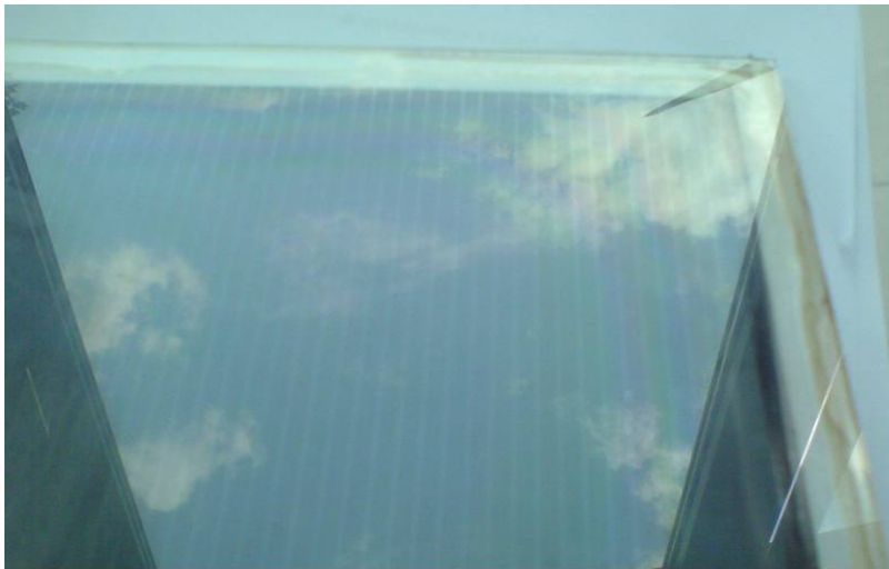
Abbildung 10 Korrosionserscheinungen auf dem Halbleiter durch eingedrungene Feuchtigkeit im Randbereich nach 500 h im Feuchte-Wärme-Test als irisierende Streifen parallel zur Außenkante sichtbar
