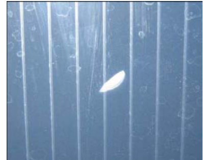
Abbildung 30 PV-Element nach der Bewitterung; rechts: optische Trübung der Folie im Kantenbereich
