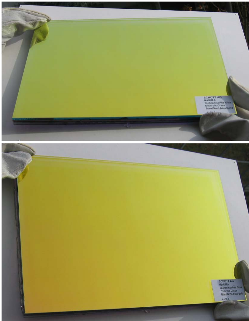
Abbildung 12 Modulmuster mit dichroitisch beschichtetem Deckglas NARIMA Blau/Gold unter verschiedenen Betrachtungswinkeln.
