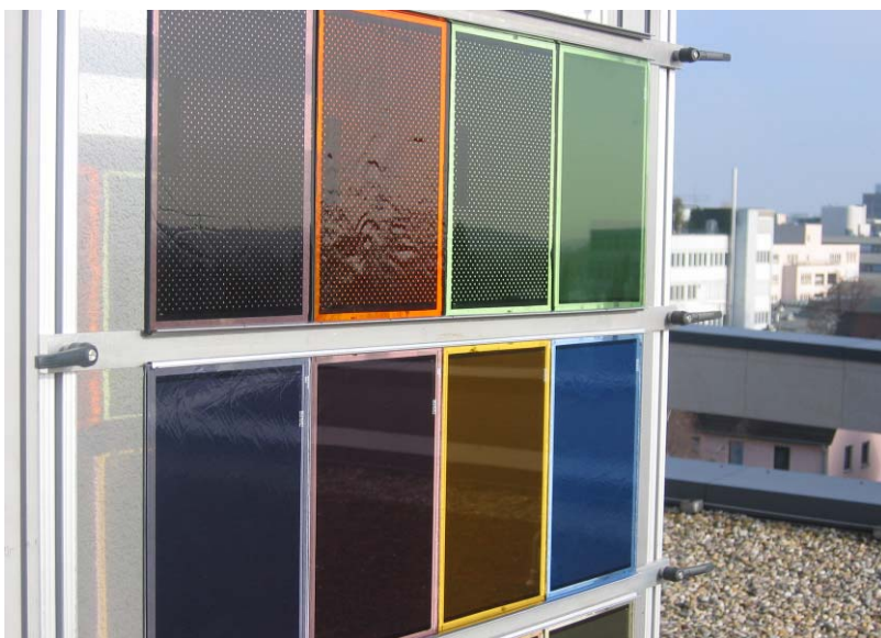
Abbildung 8 Verschiedene optisch entkoppelte Module mit sichtbarem Randbereich (hier mit transparentem Doppelklebeband als Abstandshalter)
