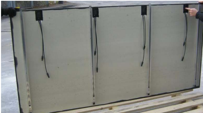
Abbildung 31 Rückseite mit Anschlussdosen und Unterkonstruktion des PV-Elements nach der Bewitterung
