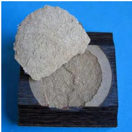
**Abbildung 36** 100 % Holzbruch MDF
