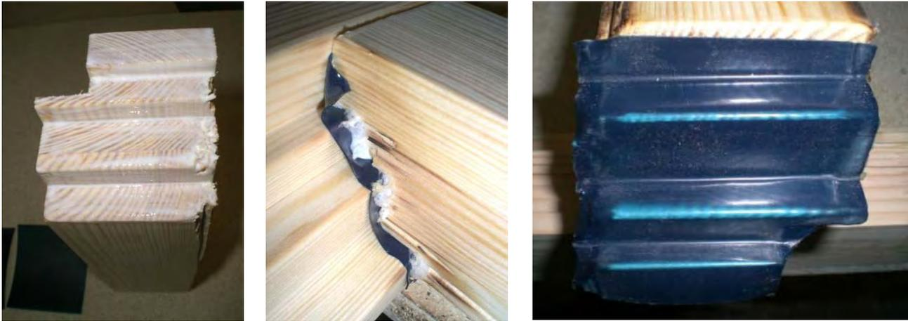
Abbildung 26: Haftungversuche der Folie auf der Stirnseite
