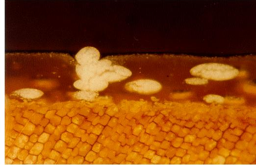
**Abbildung 10** Holzfenster mit Lasur, Lufteinschlüsse mindern die effektive Schichtdicke, teilweise durchgehende Poren
