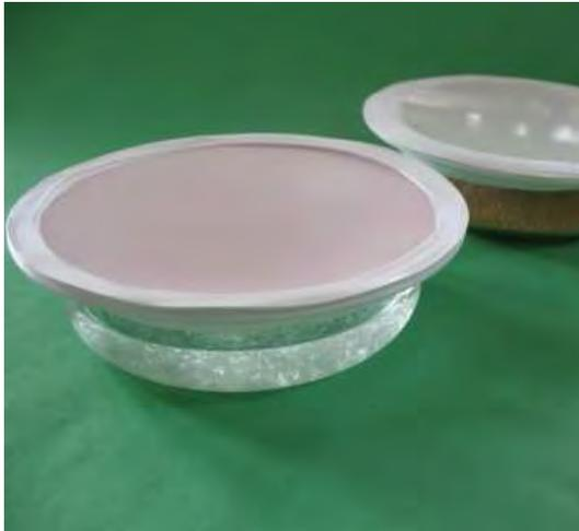
**Abbildung 13** Probekörper zur Bestimmung  $s_D$ -Wert
