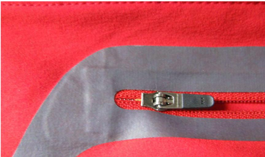
**Abbildung 72** Detail einer funktionellen Sportbekleidung: die Brusttasche und deren Reißverschluss sind mit einem aufgeklebten Formteil (grau) aus zweidimensional elastischem Material mit dem Stoff verbunden.
