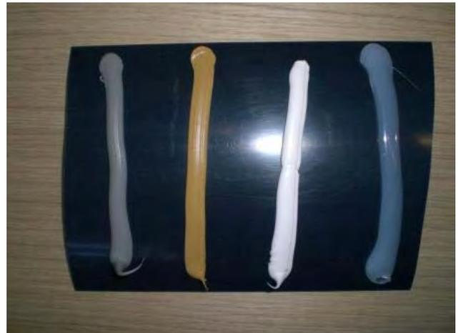
Abbildung 36: Haftungversuch Silikon auf Folie:
