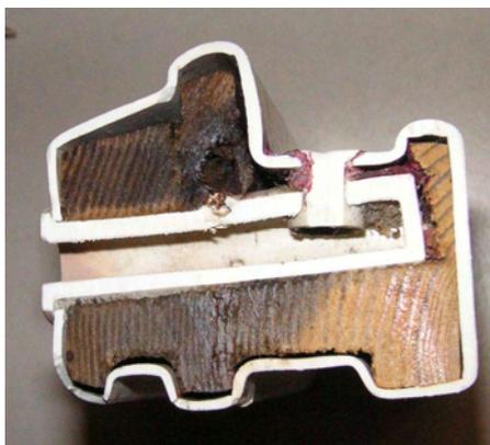
**Abbildung 7** Kunststoffummanteltes Holzfensterprofil, geschnitten im Bereich der Falzentwässerung; Befall durch holzerstörende Pilze, ausgelöst durch Eintritt von Wasser im Bereich der Entwässerungsröhrchen
