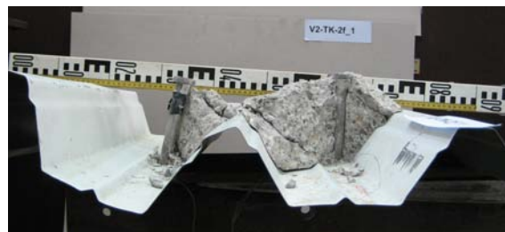
Bild 8-5: Kopfbolzenverformung V2-TK-2f Seite 1
