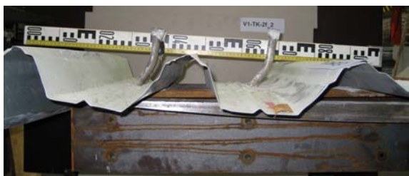
Bild 8-4: Kopfbolzenverformung V1-TK-2f Seite 2
