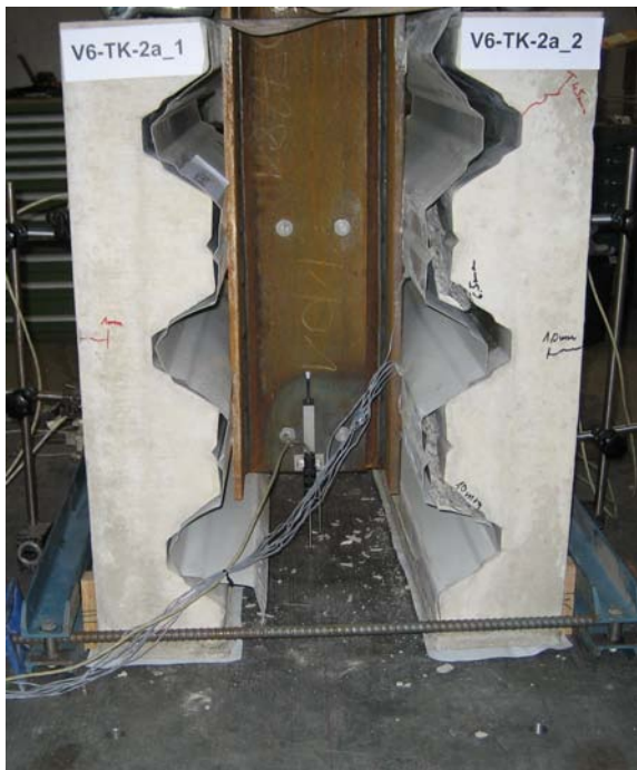
Bild 7-36: Seitenansicht V6-TK-2a bei ca. 25mm Verformung
