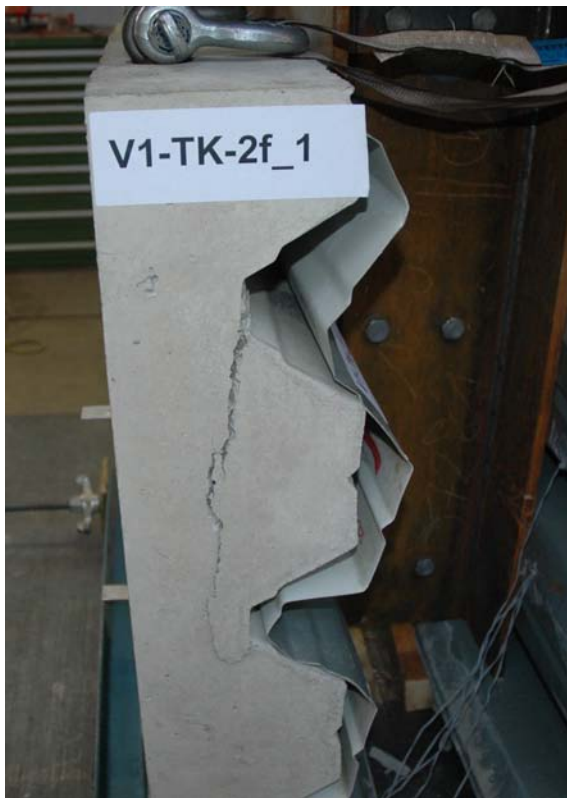
Bild 7-6: Abscheren der Sicke 1 bei V1-TK-2f
