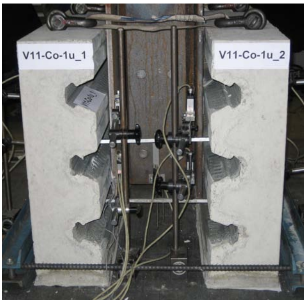
Bild 7-62: Seitenansicht V11-Co-1u kurz nach Erreichen der Traglast
