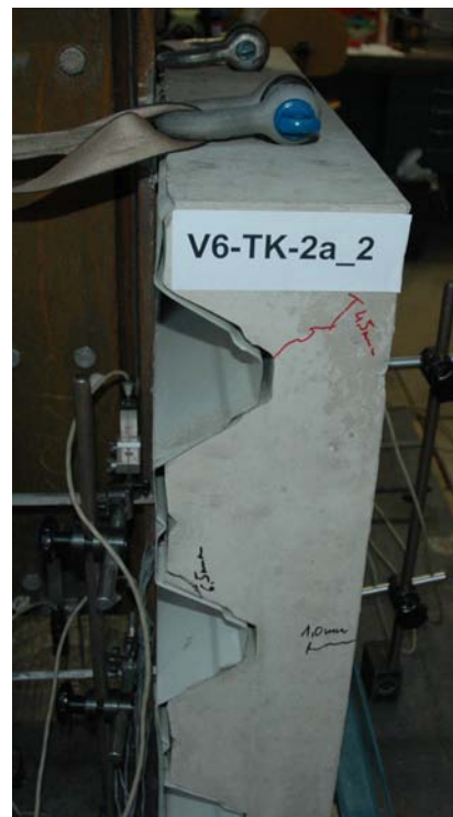
Bild 7-35: Seitenansicht V6-TK-2a bei 6,5mm Verformung
