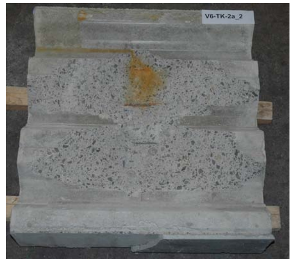
Bild 7-37: Innenansicht des Betongurts 2 von V6-TK-2a
