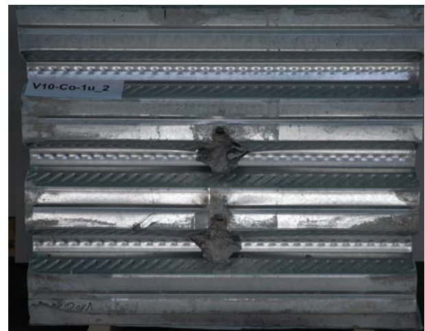
Bild 7-59: Trapezblech Innenansicht V10-Co-1u Seite 2
