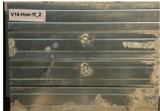
Bild 7-95: Innenansicht Trapezblech V16-Hoe-1f Seite 2 nach Versuchsende
