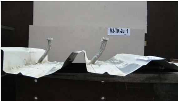
Bild 7-17: Kopfbolzenverformung am Versuchskörper V3-TK-2u_1
