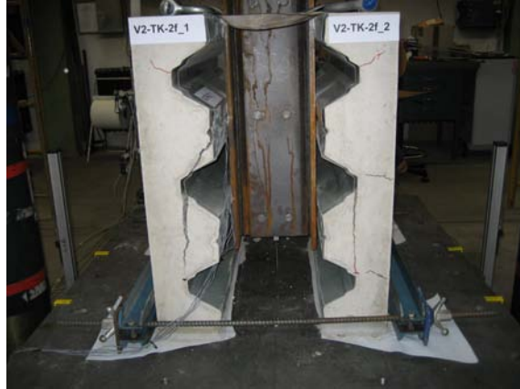
Bild 7-11: Abscheren weitere Betonsicken bei V2-TK-2f
