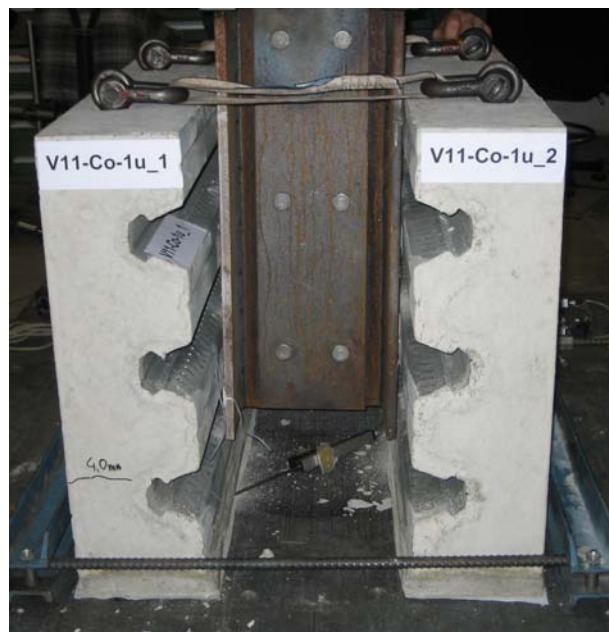
Bild 7-63: Seitenansicht V11-Co-1u kurz vor Versuchsende
