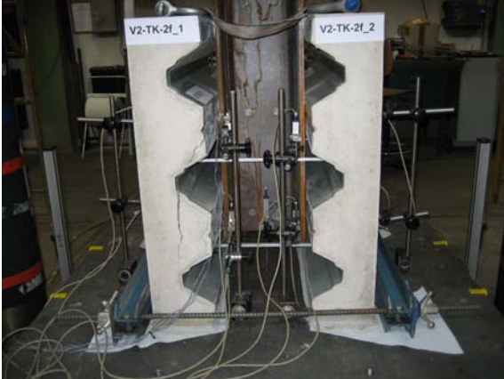
Bild 7-10: Abscheren der linken, unteren Betonsicke bei V2-TK-2f
