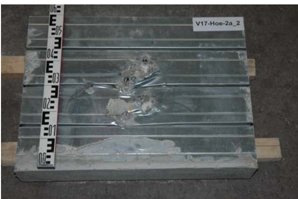
Bild 7-100: Innenansicht Trapezblech von V17-Hoe-2a Seite 2
