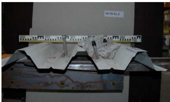
Bild 7-38: Kopfbolzenverformung am Versuchskörper V6-TK-2a_2
