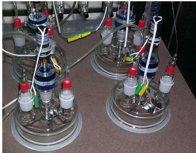
Abbildung 35: Vier Emissionszellen auf den Bodenbelag aufgesetzt, um Inhomogenitäten innerhalb einer Probe zu untersuchen.
