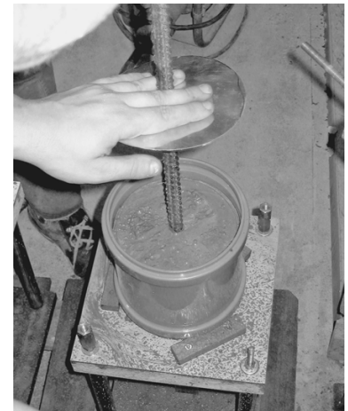
c) Aufschieben der Muffe und des Rissblechs
