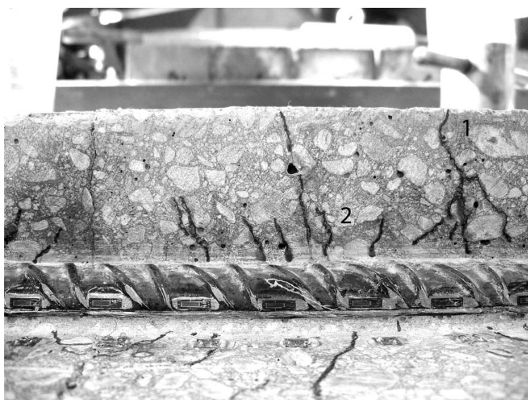
Abb. 171: Vergrößerte Aufnahme der Mikrorissbildung in der Umgebung von durchgehenden Hauptrissen
