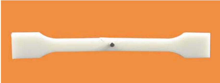
Bild 7: Probekörper mit eingedrücktem Stift nach Medienlagerung
