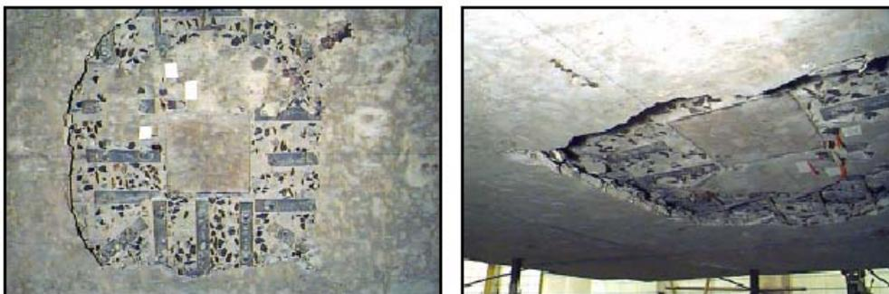
Bild 3-5: Rissbild des Versuchs M5 im Bruchzustand [20]
