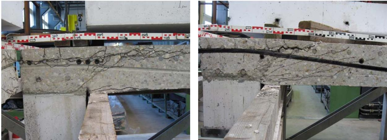
**Bild 3-17: Sägeschnitte der Versuche VV 1 (links) und VV 2 (rechts) von Hegger/Häusler [30]**
