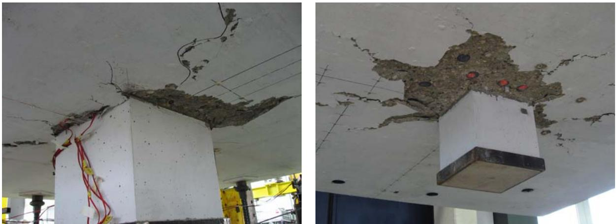
**Bild 3-18: Bruchbild auf der Plattenunterseite der Versuche VV 1 (links) und VV 3 (rechts) von Hegger/Häusler [30]**
