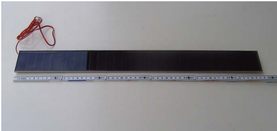
Abb. 150 Eingebettetes PV-Modul mit Verkabelung, Quelle: FG_ee
