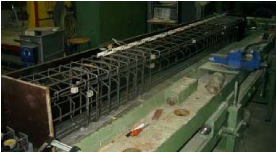
Bild 4.3: Darstellung des Bewehrungskorb im Prüfrahmen
