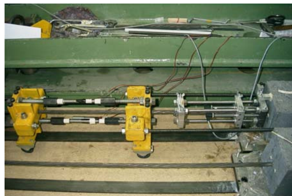
Bild 2.9: Zugmessstäbe und kardanische Aufhängung sowie Zuggestänge für die Ausziehversuche
