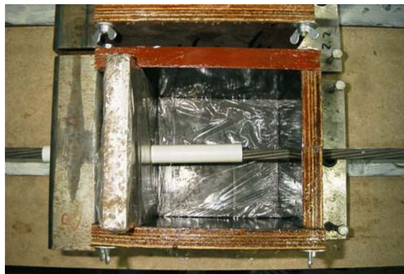
Bild 2.7: Mehrteilige Holzschalung der Probekörper
