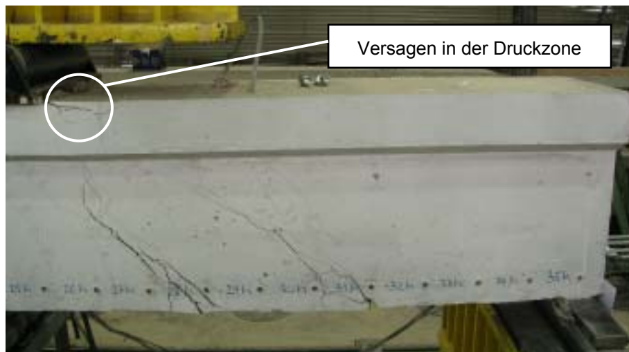
Bild 4.15: Rissbild im Bruchzustand für Balken B SVB 1 Mehlkornotyp mit 4 Litzen
