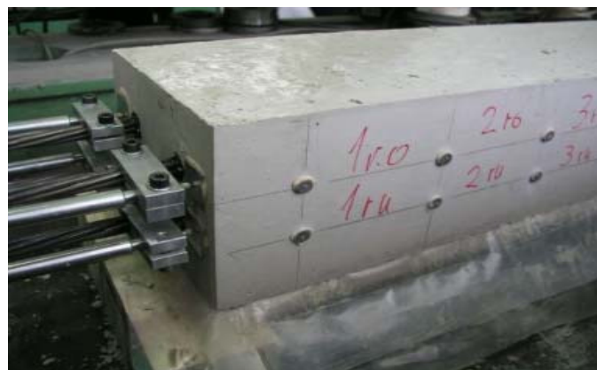
Bild 3.5: Messanordnung bei den Spannkrafteinleitungsversuchen
