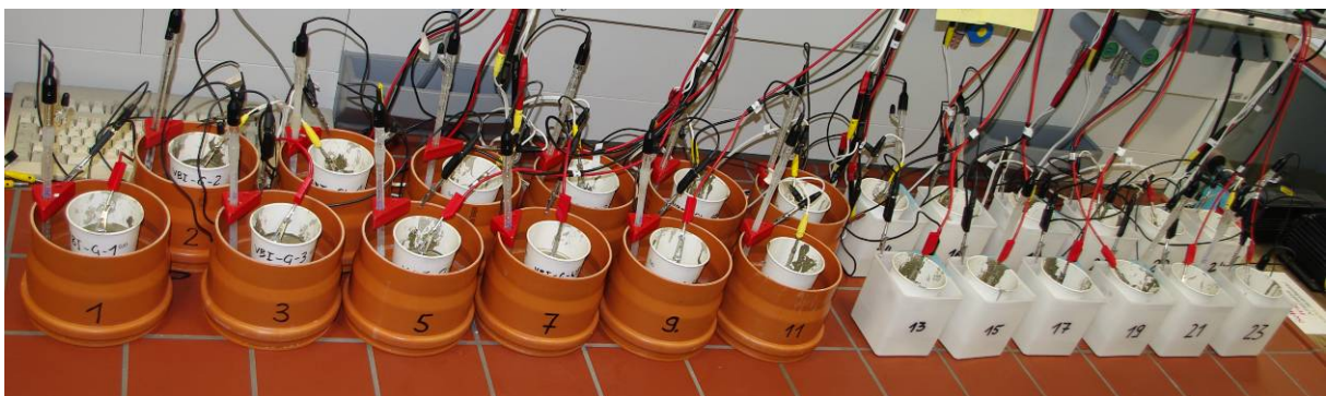
Abb. 2: Versuchsstand zur simultanen Messung der Freien Korrosionspotentiale an 24 Probekörpern mit verzinktem Stahl in verschiedenen Betonen
