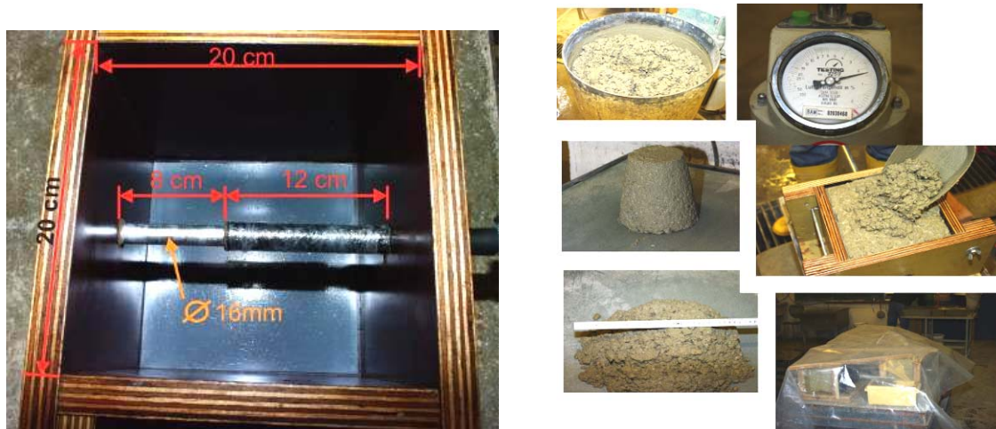
Abb. 4: links: Schalung mit vorbereitetem verzinktem Betonstahl; rechts: Herstellungsprozess
