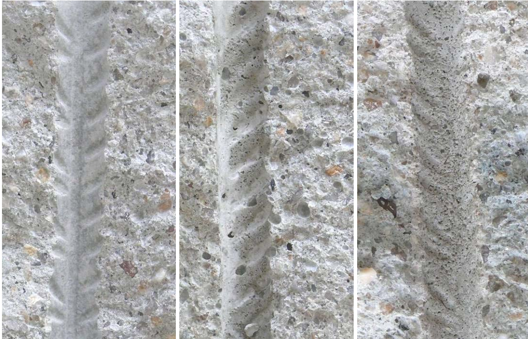
Abb. 30: Schnitt durch zerteilte Probekörper der verschiedenen chromathaltigen Betone nach Entfernung der verzinkten Stähle; v.l.n.r.: CEM I*, CEM II*, CEM III*
