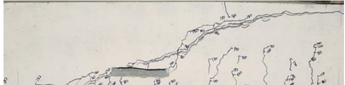
Bild 1-1: Versagensbild eines Bauteilversuchs
