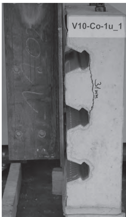
Bild 6.28: Seitenansicht des Push-Out Tests V10-Co-1u aus Kuhlmann und Konrad [40, 41]
