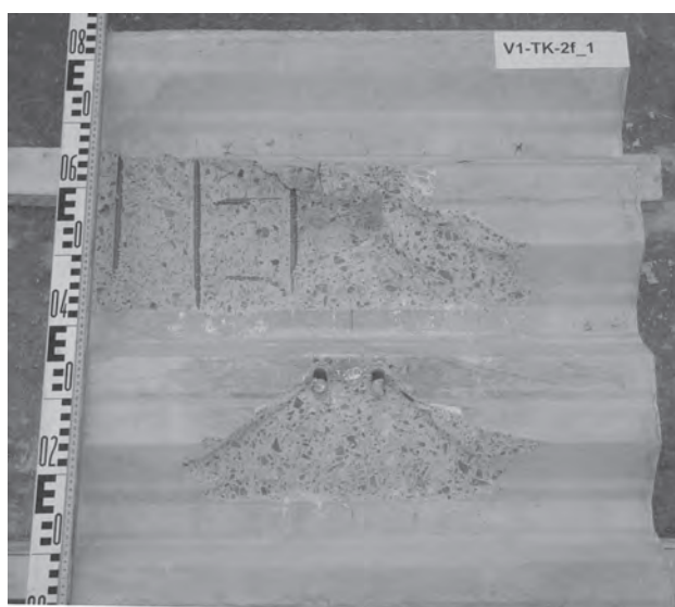
Bild 6.27: Beobachtete Versagensmechanismen des Push-Out Tests V1-TK-2f aus Kuhlmann und Konrad [40, 41]
