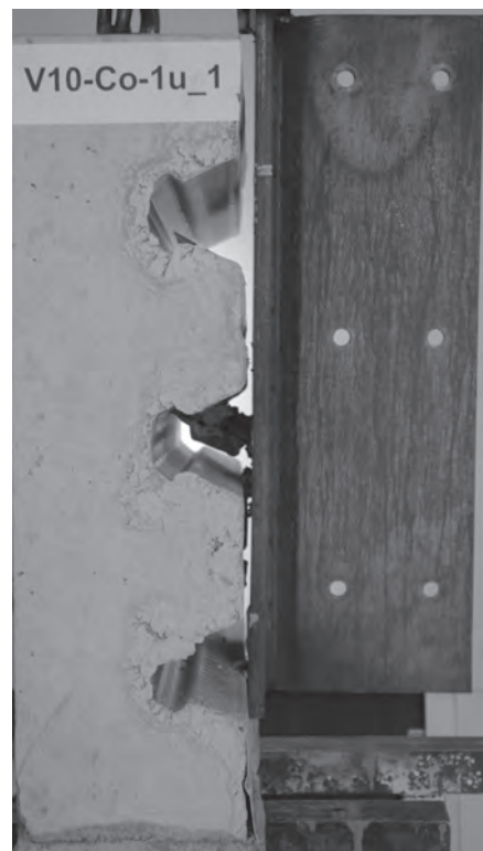
Bild 6.29: Seitenansicht des Push-Out Tests V10-Co-1u aus Kuhlmann und Konrad [40, 41]
